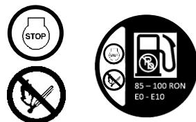
La gasolina es un líquido altamente inflamable y su vapor puede explotar. No reposte la unidad cerca de llamas. No reposte la unidad mientras el motor esté en funcionamiento. No fume cuando reposte. Antes de repostar, deje enfriar el motor. No llene el depósito en exceso. En este producto utilice solo gasolina normal sin plomo entre 85 y 100 RON. No utilice gasolina que contenga más de un 10 % de etanol.
