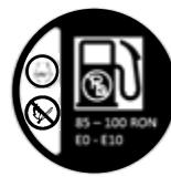
La gasolina es un líquido altamente inflamable y el vapor puede explotar. No reposte la unidad cerca de llamas. No reposte la unidad mientras el motor esté en funcionamiento. No fume cuando reposte. Antes de repostar, deje enfriar el motor. No llene el depósito en exceso. Utilice solo gasolina regular sin plomo entre 85 y 100 RON con este producto. No utilice gasolina que contenga más de un 10 % de etanol.
