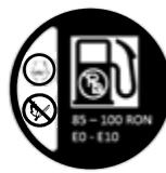
La benzina è un liquido altamente infiammabile e il vapore può esplodere. Non riempire di carburante l'apparecchio in prossimità di fiamme libere. Non riempire di carburante l'apparecchio mentre è acceso. Non fumare durante il rifornimento. Lasciare raffreddare il motore prima del rifornimento. Non riempire troppo il serbatoio. Per questo prodotto, utilizzare solo regolare benzina senza piombo nella gamma 85 - 100 RON. Non utilizzare benzina con più del 10% di contenuto di etanolo.
