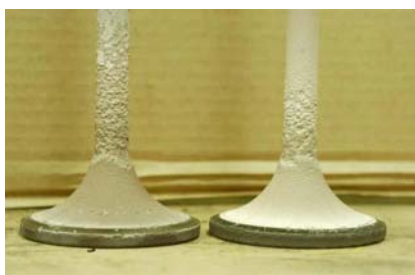
Figura 4: Válvula de escape con acumulación de siloxano
