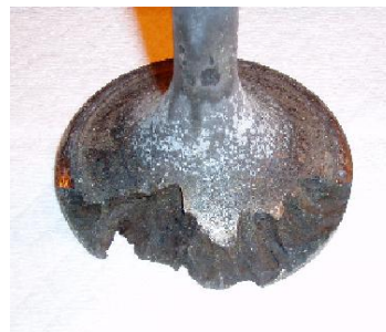
Figura 5: Corrosión figurante de la válvula
