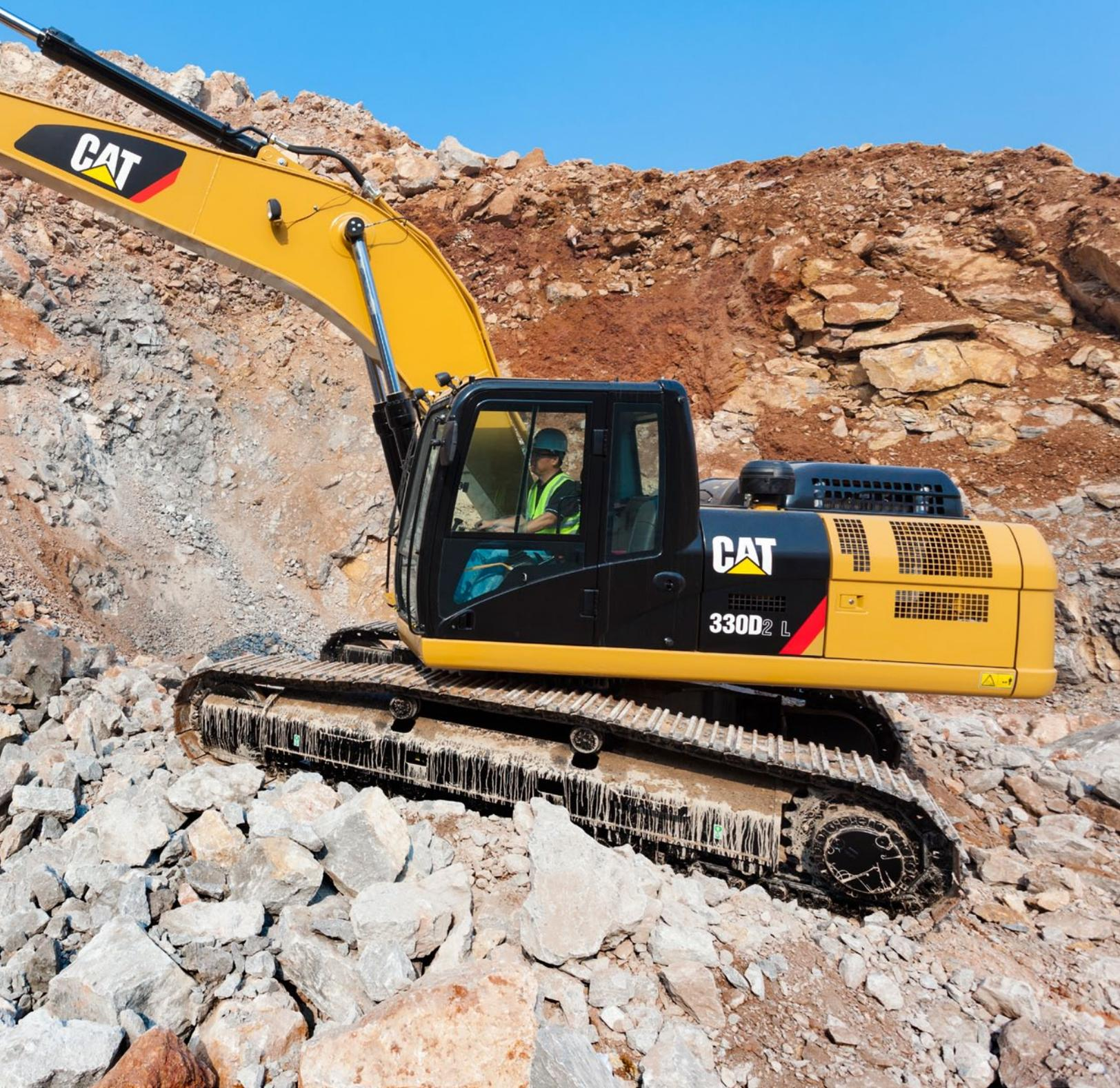
**Le modèle 330D2 L est doté d'un certain nombre de perfectionnements et de nouvelles fonctionnalités, y compris la commande de régime moteur, un nouveau système de filtration du carburant et un mode économie intégré permettant de réduire la consommation de carburant jusqu'à 15 % (par rapport au modèle 329D L conforme aux normes américaine EPA Tier 2 et européenne Stage II). Le ventilateur à vitesse variable à visco-coupleur permet de réduire le bruit et d'économiser de l'énergie.**
