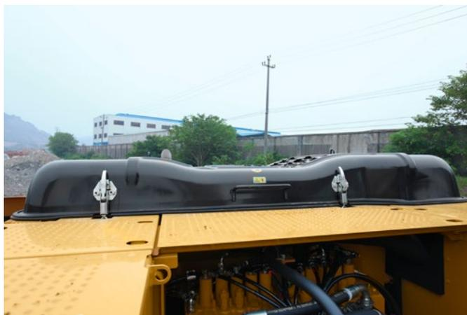
Las **planchas antideslizantes** cubren toda la estructura superior y la caja de almacenamiento para evitar el deslizamiento durante el mantenimiento. La seguridad mejora aún más con la adición de pernos abocardados para reducir los riesgos de tropezones.
