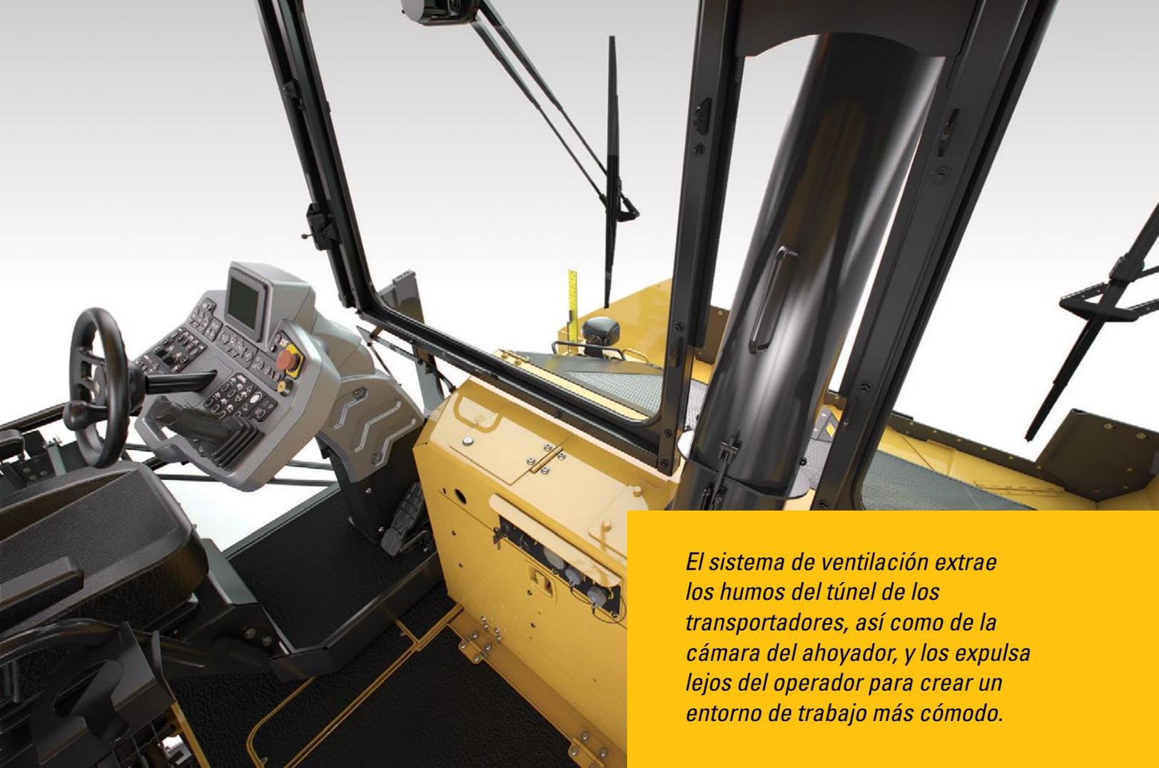
*El sistema de ventilación extrae los humos del túnel de los transportadores, así como de la cámara del ahoyador, y los expulsa lejos del operador para crear un entorno de trabajo más cómodo.*
