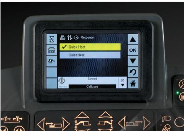
**La pantalla LCD permite una excelente visualización del modo de calentamiento silencioso o rápido. El calentamiento rápido permite ahorrar tiempo al utilizar paquetes de pavimentación anchura máxima.**
