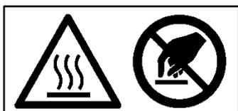
I componenti caldi possono causare ustioni o lesioni personali. Tenere i componenti caldi lontani dal corpo. Usare indumenti protettivi o dispositivi di protezione per proteggere la pelle.
