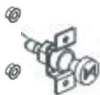
La manopola dell'aria è fissata al lato posteriore del pannello con dadi da 7 mm. Rimuovere la manopola dell'aria e il relativo cavo dal lato anteriore del pannello e togliere i dadi di fissaggio della manopola dell'aria al pannello. Rimuovere il comando valvola dell'aria dal lato posteriore del pannello. Rimontare in ordine inverso.
