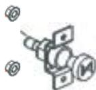
Die Drossel ist mit 7-mm-Muttern auf der Rückseite der Steuertafel befestigt. Entfernen Sie den Drosselknopf und das Kabel von der Vorderseite der Steuertafel sowie die Muttern, mit denen die Drossel an der Steuertafel befestigt ist. Entfernen Sie den Drosselregler
