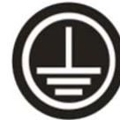
Dieses Symbol kennzeichnet die Erdleitung. Lesen Sie den Artikel „Generator-Erdung“, der weitere Informationen zur Erdung des Generators enthält.
