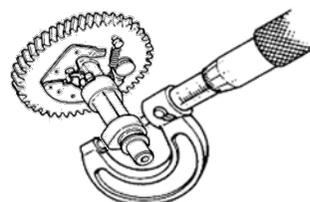
Inspectez l'arbre à cames afin de s'assurer qu'il n'y a aucun dommage ou usure anormale. Mesurez la levée des lobes de l'arbre à cames. La limite acceptable pour la levée est indiquée dans le tableau ci-dessous. Si la levée se trouve en dehors de la plage acceptable, remplacez l'arbre à cames.
