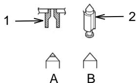
Vérifiez l'usure du siège de soupape (1) et de la valve à flotteur (2). La figure A montre une valve à flotteur usagée qui a besoin d'être remplacée. La figure B montre une valve à flotteur qui peut être réutilisée.
