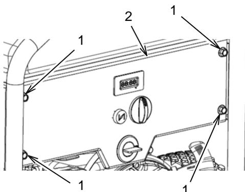
Dévissez les boulons (1) et les rondelles. Tirez lentement le panneau de commande (2) vers l'avant. Vérifiez que les câbles peuvent bouger librement et ne sont pas endommagés. Marquez les câbles pour les identifier, puis débranchez les faisceaux de câbles.
