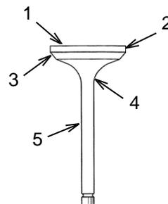
Vérifiez si les soupapes sont usées. Vérifiez si la culasse (1), le bord de la soupape (2) et le collet de la soupape (3) sont endommagés ou comportent des surfaces brûlées. Vérifiez que le col de soupape (4) n'est pas anormalement usé. Vérifiez si la tige de soupape (5) est usagée, comporte des rainures ou des courbures. En cas de dommages, remplacez la soupape.
