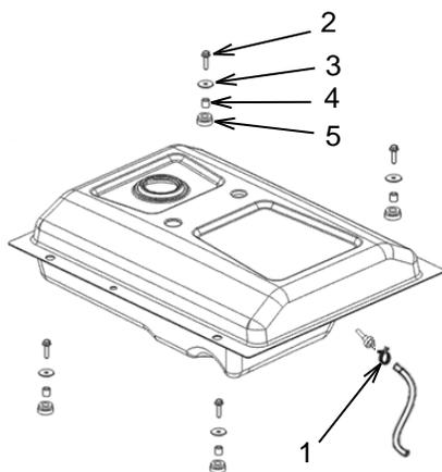
Retirez le collier de serrage (1) et la conduite d'alimentation en carburant du filtre à carburant. Retirez les quatre boulons (2), les rondelles (3), les bagues (4), et les manchons (5). Soulevez le réservoir de carburant.
