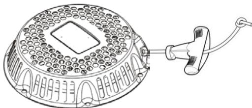
Enroulez le cordon autour de la poulie. Tirez légèrement sur le cordon et placez son extrémité dans le logement. Puis placez son extrémité dans la poignée. Faites un nœud à l'extrémité et laissez le ressort tirer la poignée vers le logement. Tirez légèrement pour vérifier que le système fonctionne correctement.
