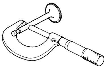
Utilisez un micromètre pour mesurer le diamètre extérieur de la tige de soupape. Consultez le tableau suivant.
