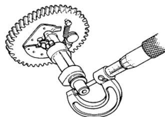
Mesurez le diamètre extérieur de l'arbre à cames. Le diamètre normal est de 13,984 mm. Si le diamètre est de 13,916 mm ou moins, remplacez l'arbre à cames.
