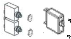
Chaque protecteur de surintensité de bouton est fixé au panneau à l'aide d'un demi-écrou qui se trouve sur la partie avant du panneau. Les disjoncteurs type commutateurs sont fixés au panneau à l'aide de vis d'assemblage. Marquez les câbles pour les identifier, puis débranchez le disjoncteur ou le protecteur de surintensité. Retirez le demi-écrou de la partie avant du panneau, puis retirez le disjoncteur ou le protecteur de surintensité de l'arrière du panneau.
