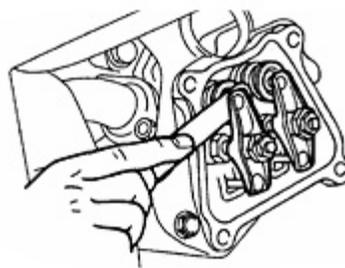
Mesurez le jeu de la soupape avec une jauge d'épaisseur. Consultez le tableau suivant.
