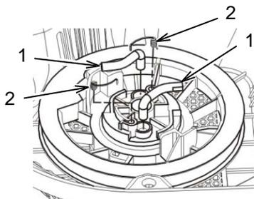
Placez les cames d'entraînement du démarreur (1) sur la poulie du démarreur manuel, installez les ressorts de rappel (2) sur la poulie et accrochez-les sur le côté des cames d'entraînement.
