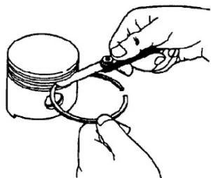
Mesurez le jeu de la bague, comme illustré. Le jeu normal est compris entre 0,015 et 0,045 mm. Si le jeu est de 0,15 mm ou plus, remplacez le piston.
