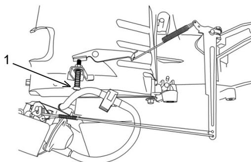
Le régime maximal de ce moteur est de 3 730 à 3 830 tr / min. Faites tourner la vis de réglage (1) dans le sens horaire pour augmenter le régime du moteur. Faites tourner la vis de réglage dans le sens anti-horaire pour diminuer le régime du moteur. Si ces manipulations ne permettent pas de régler le régime du moteur dans la plage mentionnée, consultez la section Régulateur - Réglage.
