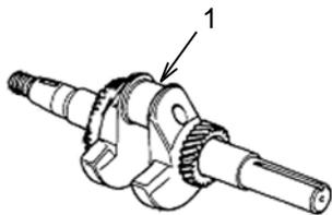
Vérifiez le diamètre du tourillon de vilebrequin (1). Un diamètre normal est de 30,190 mm. Si le diamètre est de 30,175 mm ou moins, remplacez le vilebrequin.
