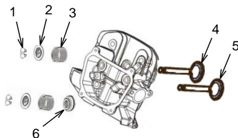
**N.B. :** Ne retirez pas les bagues d'arrêt (2) si la culasse est encore sur le moteur ; à défaut, les soupapes tomberont dans le cylindre.
