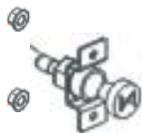
Le starter est fixé à l'arrière du panneau à l'aide d'écrous de 7 mm. Retirez la commande du starter et le câble de la partie avant du panneau, puis retirez les écrous qui fixent le starter sur le panneau. Retirez la commande du starter de l'arrière du panneau. Réinstallez-le dans l'ordre
