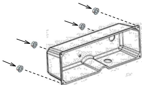
Placez la partie avant du panneau de commande sur une surface qui le protégera de tout dommage. Retirez les quatre écrous de 7 mm de l'arrière du boîtier du panneau de commande et séparez soigneusement le boîtier de la partie avant du panneau.
