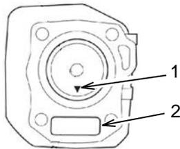
Enduisez le piston, les bagues et la paroi du cylindre d'huile moteur. Utilisez un compresseur à bague pour pousser les bagues et insérez le piston dans le cylindre. Vérifiez que la marque sur la tête de piston (1) s'aligne avec la marque du poussoir (2) sur le carter moteur. Utilisez un entraîneur de piston pour pousser le piston hors du compresseur à bague et dans le cylindre.
