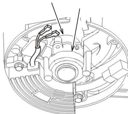
Retirez la brosse. Utilisez un ohmmètre ou un multimètre pour mesurer la résistance de la bague collectrice aux points indiqués. La résistance doit être de  $58.5 \Omega \pm 10 \%$  à  $25^\circ \text{C}$ . Si la résistance est hors du seuil de tolérance, nettoyez la bague collectrice et effectuez un autre test. Remplacez le générateur si nécessaire.
