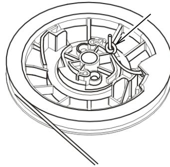
Faites passer le cordon du démarreur manuel dans le trou de la poulie de ce dernier et faites un nœud à l'extrémité du cordon, comme indiqué ci-dessus.
