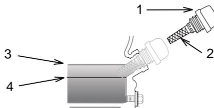
1. Retirez le bouchon de l'orifice de remplissage d'huile (1) et essuyez la jauge de niveau d'huile (2) pour la nettoyer.
