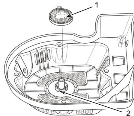
Mettez le crochet intérieur (1) du ressort du démarreur manuel dans la gorge (2) du boîtier de ce dernier et placez le ressort du démarreur manuel dans le boîtier. Maintenez le ressort en place.
