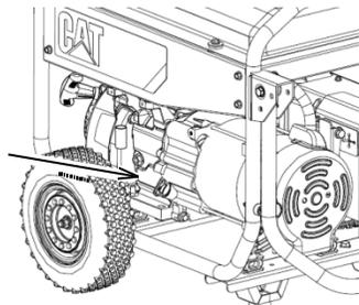
Les groupes électrogènes Cat<sup>®</sup> sont identifiés à l'aide de numéros de modèle, de numéros de série et de spécifications de performance. Le numéro de série est gravé sur le bloc-moteur près de l'orifice de remplissage d'huile.
