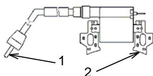
Mesurez la résistance de la bobine secondaire en connectant un fil d'un ohmmètre au câble de la bougie d'allumage (1) et en connectant l'autre fil au châssis métallique (2). Si la résistance ne trouve pas dans la plage 5,9 à 7,1 k $\Omega$ , remplacez la bobine.
