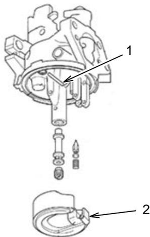
Retirez l'axe de flotteur (1), puis retirez le flotteur (2) en faisant attention aux petites pièces. Nettoyez les pièces internes avec un nettoyant pour carburateur et de l'air comprimé.
