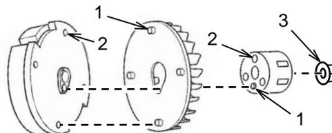
Alignez les pions de positionnement (1) sur le démarreur et sur les deux côtés de la turbine avec
