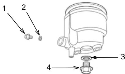
Vidangez le carburant de la cuve en retirant le boulon de vidange (1) et le joint (2). Utilisez un récipient adapté pour collecter le carburant. Éliminez le carburant usagé auprès des services d'élimination des déchets agréés. Retirez le carburateur. Retirez le boulon (4) et le joint (3). Retirez prudemment la cuve et retenez les petites pièces qui sont susceptibles de tomber.
