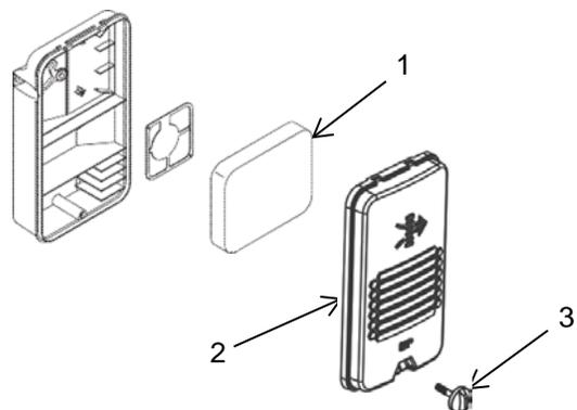
Retirez le boulon du couvercle de filtre à air (3) et déposez le couvercle du filtre à air (2). Vérifiez que le filtre à air (1) est propre et intact. Lavez le filtre à air s'il est encrassé. Remplacez le filtre à air s'il est endommagé.
