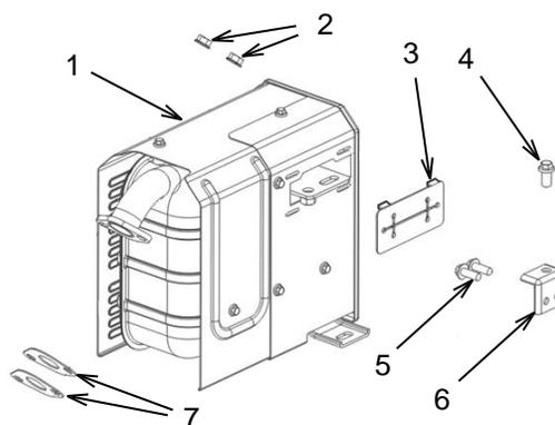
Retirez les écrous (2). Retirez les boulons (4) et (5), puis retirez le support (6) et la plaque (3). Soulevez le silencieux d'échappement (1) hors des goujons de fixation. Jetez les joints utilisés (7). Il n'est pas recommandé d'enlever le couvercle du silencieux d'échappement. Réinstallez en suivant l'ordre inverse et en utilisant de nouveaux joints (7). Pour l'entretien de l'écran, consultez la section Ecran - Inspection/Nettoyage/ Remplacement.
