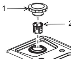
Essuyez le bouchon de carburant (1) et la surface environnante avant de retirer le bouchon de carburant. L'essuyage du bouchon de carburant et de sa surface environnante avant le retrait du bouchon permet de réduire les éléments contaminants pouvant pénétrer dans le circuit de carburant.
