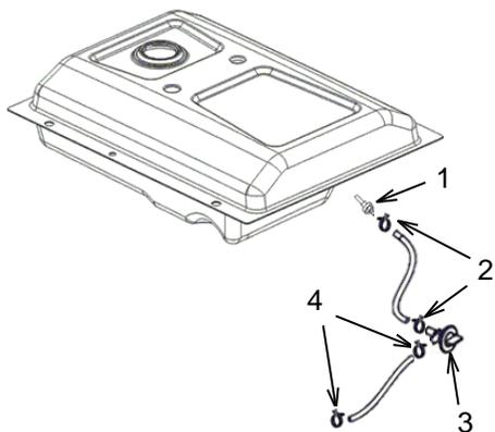
Vidangez le carburant du réservoir de carburant dans un récipient adapté. Éliminez le carburant usagé conformément à la réglementation. Démarrez le moteur et laissez-le tourner hors du seuil de carburant. Tournez l'interrupteur du groupe électrogène en position d'arrêt « 0 ».
