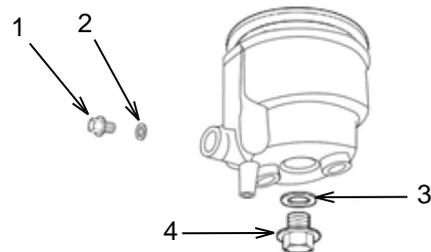
Installez le bouchon de vidange (1) et le joint (2) dans la cuve. Placez la cuve de façon à ce que le boulon de vidange puisse être accessible depuis l'extérieur de l'unité. Installez le joint (3) et le boulon (4) pour maintenir la cuve en place. Réinstallez le carburateur. Après avoir démarré l'unité, vérifiez qu'il n'y a pas de fuite. Faites fonctionner le moteur jusqu'à atteindre la température de fonctionnement normale et ajustez la guide de vis pour atteindre la bonne vitesse de ralenti.
