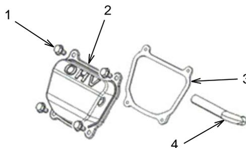
Retirez les boulons des couvercles de soupapes (1), le tuyau du reniflard (4), le couvercle de soupape (2), et le joint pour couvercle de vanne (3).
