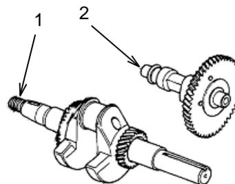
Inspectez les pignons sur et le vilebrequin (1) et l'arbre à cames (2). S'ils sont usés ou si les dents sont cassées, remplacez-les. Vérifiez les engagements des pignons. Si l'emboîtement des pignons est trop lâche, le moteur sera plus bruyant que la normale. Il est recommandé de remplacer les pignons si l'engagement est trop lâche. Si vous devez remplacer les pignons ou les arbres, remplacez-les un à un pour diminuer les risques de montage incorrect.
