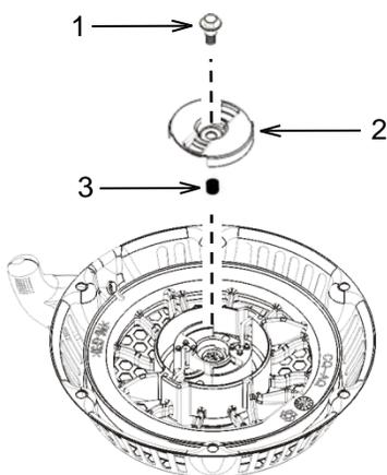
Installez le ressort (3), le guide d'entraînement (2), et la vis de fixation (1). Serrez la vis de fixation à  $9 \pm 1$  N m.
