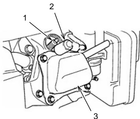
Retirez le capuchon de la bougie d'allumage (2), la bougie d'allumage (1), le couvercle de soupape (3), et le joint couvre-soupape. Tirez légèrement sur le démarreur manuel jusqu'à ce que le piston soit au point mort haut.
