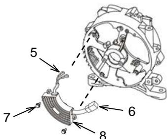
Débranchez tous les fils (5) de la brosse et le connecteur (6). Dévissez les boulons (7), puis retirez le régulateur de tension (8). Réinstallez-le dans l'ordre inverse. Le fil rouge passe sur la borne « + » de la brosse. Le fil blanc passe sur la borne « - » de la brosse.
