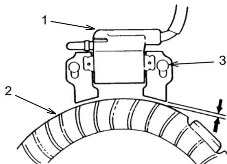
Utilisez une jauge d'épaisseur pour mesurer le jeu entre la bobine d'allumage (1) et le volant d'inertie (2). Le jeu doit être mesuré dans une plage de 0,4 à 0,6 mm. Si le jeu est en dehors de la plage acceptable, desserrez les vis (3) et déplacez la bobine pour que le jeu soit dans la plage. Resserrez les vis.
