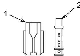
Inspectez le gicleur principal de carburant (1) et l'injecteur de carburant principal (2). Remplacez-les en cas d'usure.
