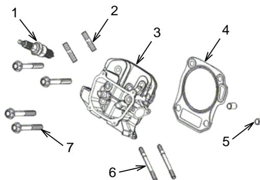
Retirez la bougie d'allumage (1). Retirez les boulons de la culasse (7), puis retirez la culasse (3). Retirez le joint de culasse (4) et jetez le joint usagé. Retirez les pions de positionnement (5) et mettez-les de côté. Les tourillons (2) et (6)
