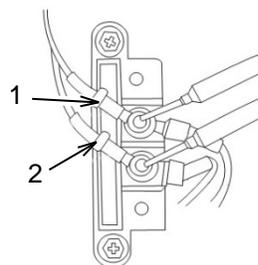
Sur le bornier, utilisez un ohmmètre ou un multimètre pour mesurer la résistance de l'enroulement principal. Placez le compteur sur le fil blanc (1) et sur le fil marron (2). La résistance doit être de  $0,35 \Omega \pm 10 \%$  à  $25^\circ \text{C}$ . Si la résistance est hors du seuil de tolérance, remplacez le générateur. Mesurez la résistance des fils à la connexion de terre. La résistance doit être infinie. Si la résistance n'est pas infinie, remplacez le générateur.
