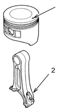
Placez la bielle dans le piston de façon à ce que son côté le plus long (2) soit aligné par rapport à la marque sur la tête de piston (1). Insérez l'axe de piston dans un côté du piston, dans la bielle, et faites ressortir de l'autre côté du piston.
