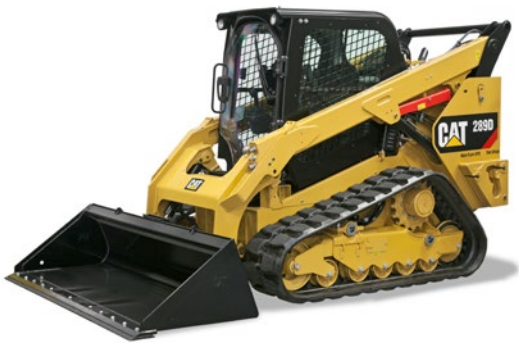
Рычажный механизм с вертикальным подъемом
