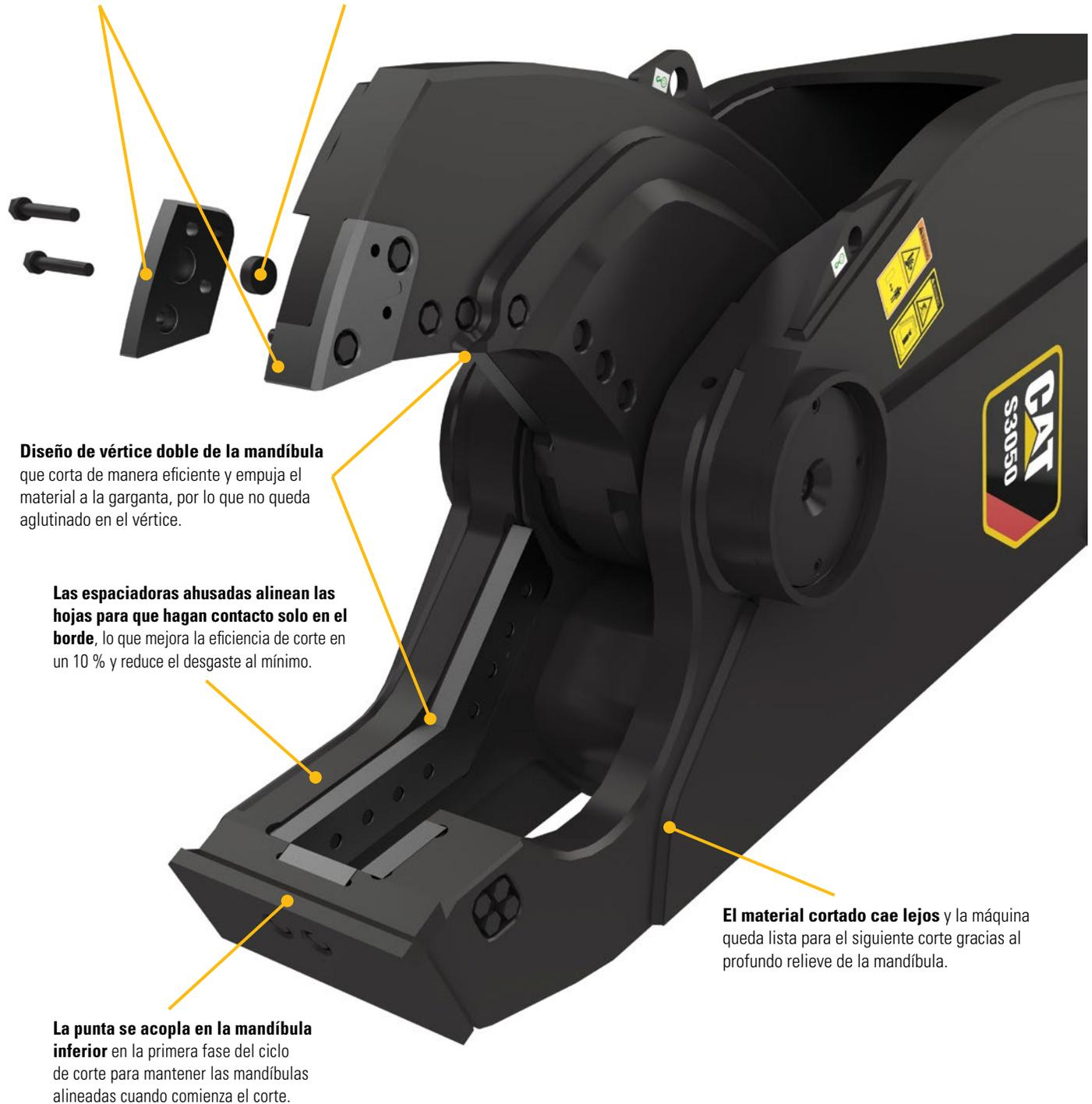
**Diseño de vértice doble de la mandíbula** que corta de manera eficiente y empuja el material a la garganta, por lo que no queda aglutinado en el vértice.
