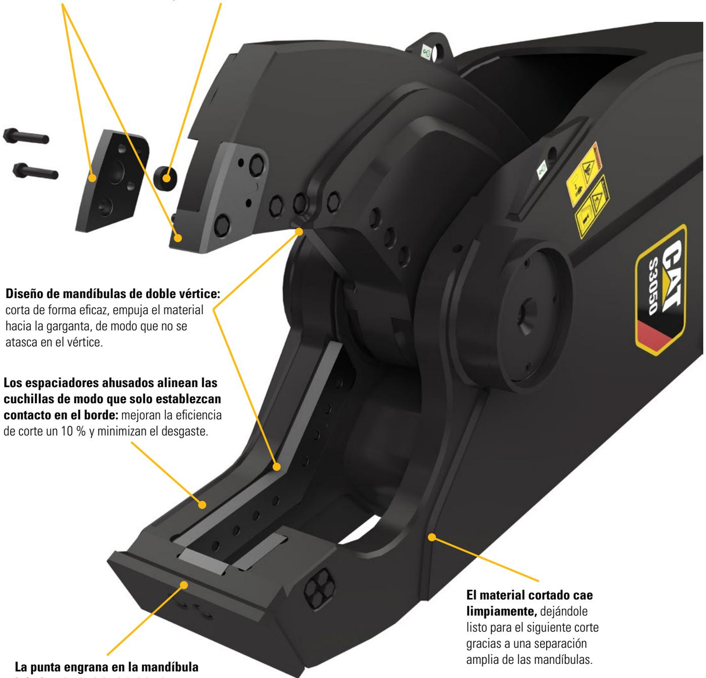
**Diseño de mandíbulas de doble vértice:** corta de forma eficaz, empuja el material hacia la garganta, de modo que no se atasca en el vértice.
