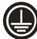
Dieses Symbol kennzeichnet die Erdleitung. Beziehen auf Sie den Artikel "Erdung des Generators" für zusätzliche Informationen über den Generatorerdung.
