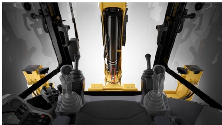
Le modèle 444F2 est doté de commandes entièrement asservies pour un fonctionnement sans effort. Il est possible de choisir entre la grille de commande de la pelle rétro (SAE) et celle de la pelle hydraulique (ISO) en appuyant sur un simple bouton. Elle offre un accès facile et sûr aux conducteurs, quelle que soit leur expérience ou leur capacité.
