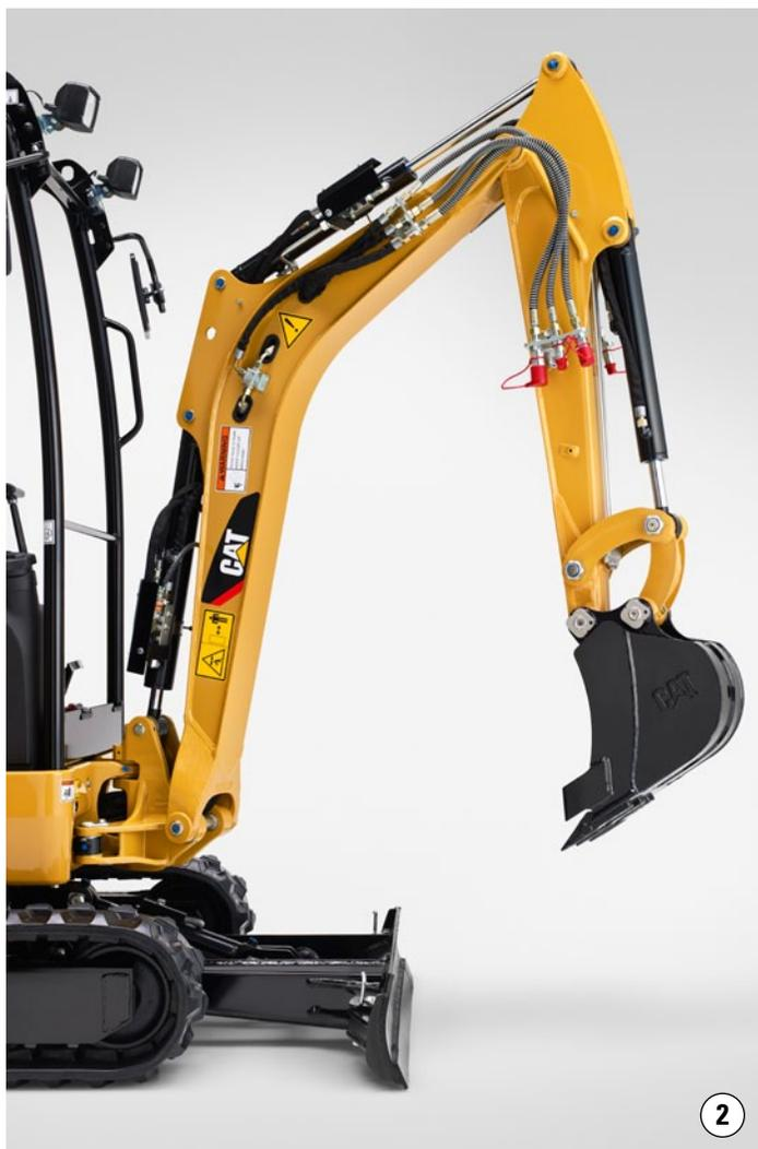
可随时投入使用的快速断开接头标配一个蓄能器，使作业机具的释放和更换变得快捷而轻松。它们靠近无尾回转布置，因此减少了软管长度并最大限度避免了潜在的损坏。
