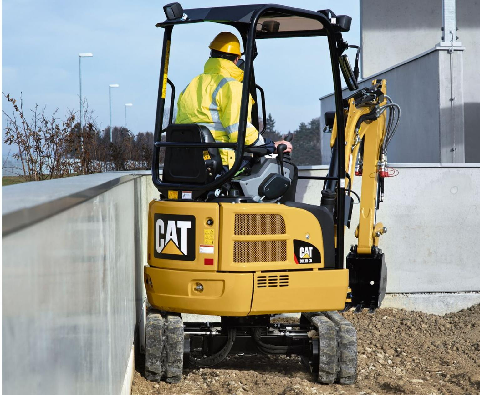
Cat 301.7D CR 采用无尾回转设计，可让上部机架在履带宽度范围内回转，因此在狭窄的工作区域也能够应对自如。这种紧凑型半径设计还可以让您专注于正在执行的工作，而不必担心对机器后部或现场造成损坏。
