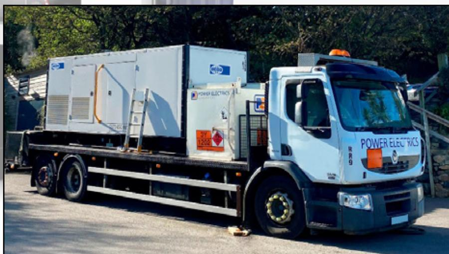
Автомобиль быстрого реагирования, созданный для быстрого реагирования, предназначен для быстрой доставки на объекты и не требует разгрузки для подачи электроэнергии.
