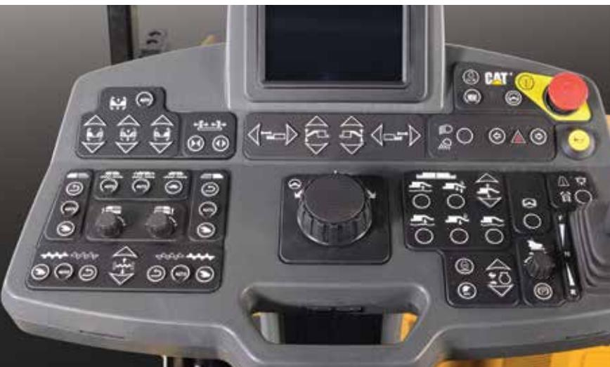
يستخدم الرافص AP655F ذو الجنزير الفولاذي قرصاً بدلاً من عجلة التوجيه القياسية.
