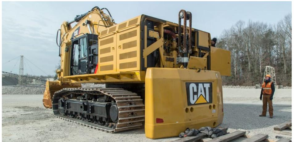
El sistema de retención del bulón PPR2 (Positive Pin Retention 2) evita que se afloje el bulón de la cadena del eslabón de la cadena, reduce las concentraciones de esfuerzos y elimina el movimiento del bulón para aumentar la vida útil.
