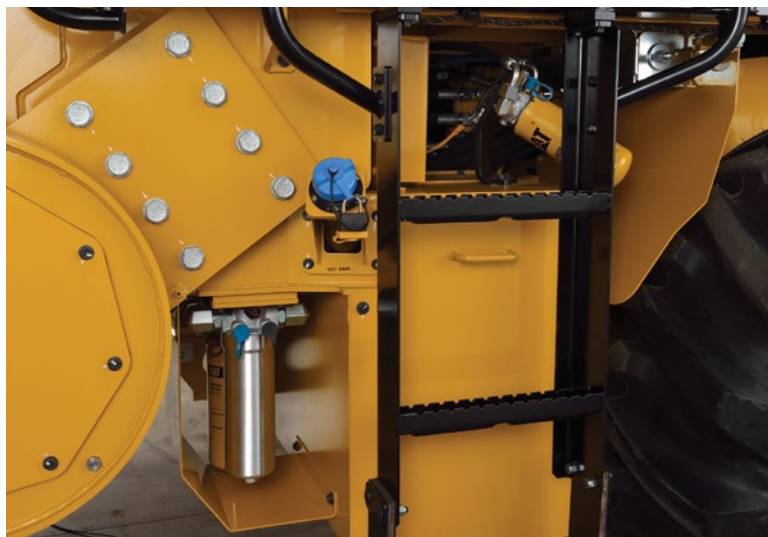
左图： 易于检修液压滤清器和 DEF 加注口
