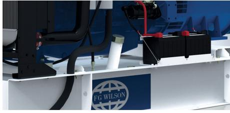
Un ancho tubo de llenado del depósito de combustible de 3" permite un acceso y un llenado fácil, mientras que las válvulas del tubo de drenaje de aceite y de drenaje del líquido refrigerante proporcionan la accesibilidad necesaria para el mantenimiento. La bancada cuenta también con puntos de arrastre de serie que facilitan el transporte y reducen el riesgo de sufrir daños durante el traslado con carretilla elevadora o al efectuar otra clase de manipulación.
