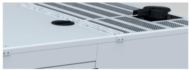
Todas las juntas del techo están reforzadas con uniones de solape que emplean sellos de caucho de butilo, por lo que ofrecen una protección sin igual frente a la entrada de agua en condiciones extremas. Los bordes curvados garantizan una carena con una estructura rígida y estéticamente agradable. Al radiador se accede por medio de una clapeta antilluvia encastrada con sello de compresión; una protección mayor frente a la entrada de agua.
