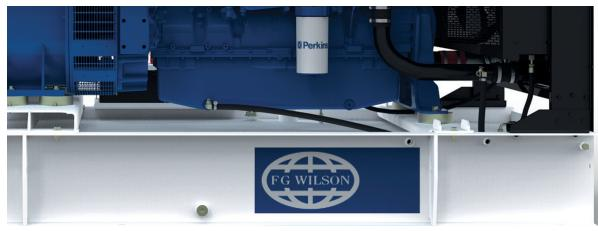
El diseño del depósito de combustible incluye una placa superior reforzada e inclinada para permitir la salida de líquidos, que actúa a modo de zona de recogida de posibles derrames o fugas de líquido. Una placa inferior inclinada y un tapón de drenaje con muescas permiten un drenaje eficaz y controlado del depósito de combustible. El diseño del depósito permite un funcionamiento de 8 horas con carga completa en aplicaciones continuas.
