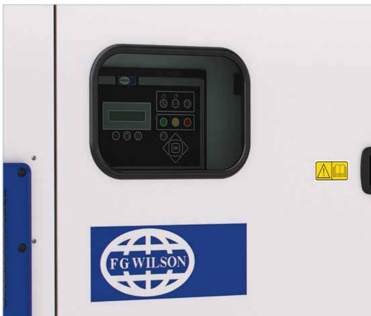
Las condiciones de funcionamiento del grupo electrógeno se pueden controlar con facilidad por medio de la amplia ventana, mientras que un botón adicional de parada de emergencia se encuentra convenientemente situado al lado del panel de control, en la parte exterior de la carena. Se puede acceder a los cables directamente desde la parte inferior del panel de control, a través del extremo de la bancada.
