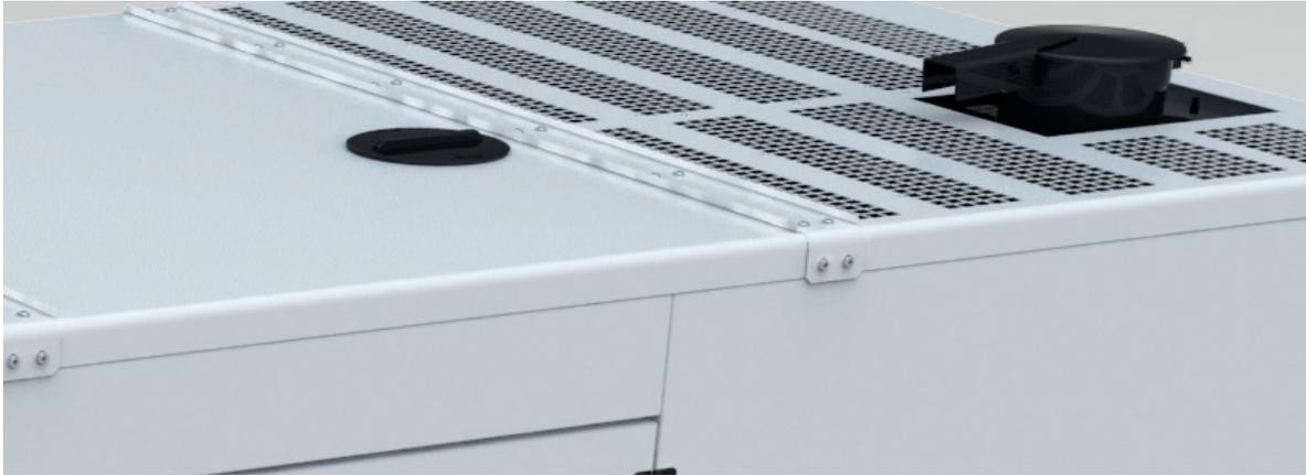
Tous les joints de capot sont renforcés par un système à recouvrement en caoutchouc butyle et assurent une protection incomparable contre l'infiltration d'eau dans des conditions extrêmes. Les bords arrondis confèrent rigidité et esthétique à la structure du capotage. Le radiateur est accessible via un clapet pare-pluie encastré doté d'un joint torique, formant une protection supplémentaire contre l'infiltration d'eau.
