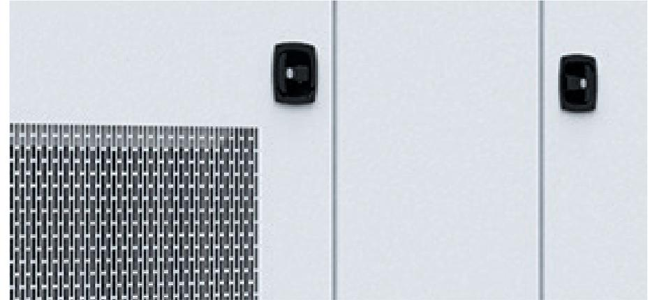
Les serrures rotatives étanches assurent l'étanchéité de la porte en alignement avec le cadre du capotage pour empêcher l'eau de s'infiltrer ; les joints de porte inclinés et les découpes étudiées de la grille assurent quant à eux l'écoulement optimal de l'eau.
