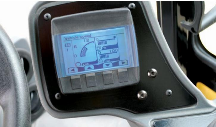
*Layar LCD multi-fungsi menyediakan instrumentasi digital, diagnostik mandiri, dan pengukuran pemadatan dasar dalam waktu nyata (opsional), agar operator dapat mencapai kinerja yang lebih baik di lokasi kerja secara keseluruhan.*
