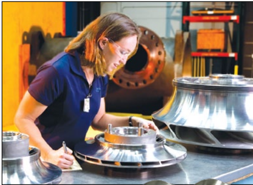
Inspección del impulsor
