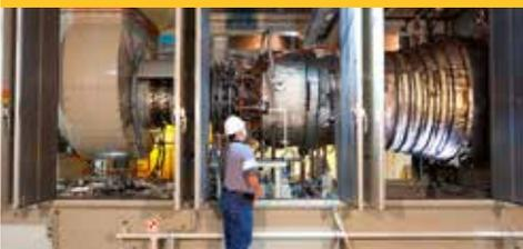
Solar construye una turbina remanufacturada según las especificaciones originales y las mejoras actuales del producto.
