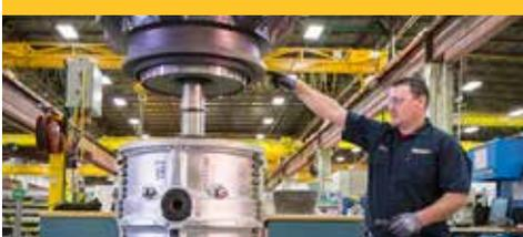
La turbina original se desarma e inspecciona.
