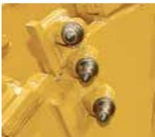
**La disposition des pics de coupe par trois et en éventail aux extrémités du rotor permet d'éliminer les débris et de réduire l'usure du rotor lors de manœuvres pendant la coupe.**
