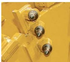
A colocação de broca de corte em árvore tripla nas extremidades do rotor coleta materiais soltos e reduz o desgaste no rotor causado por manobras durante o corte.
