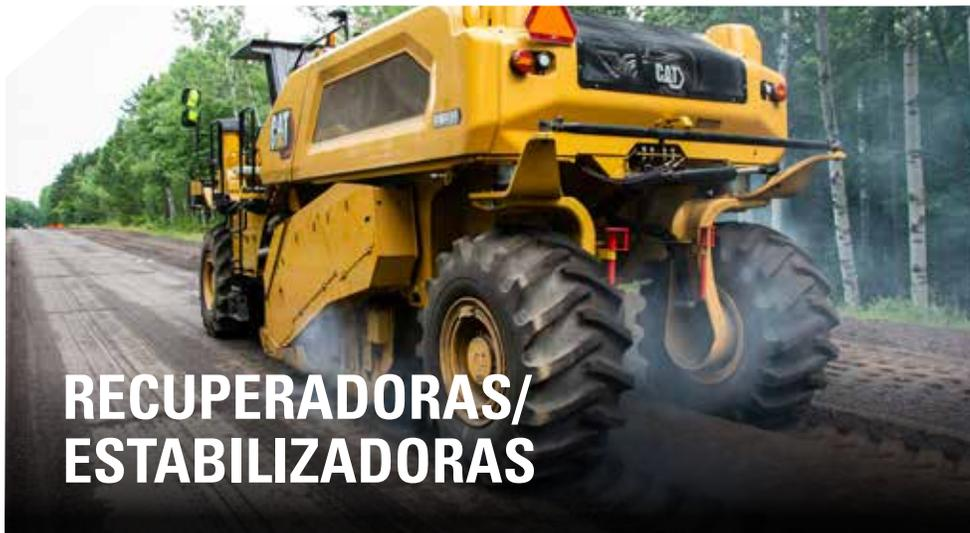
As recuperadoras de rodovias/estabilizadores de solo Cat pulverizam a camada de asfalto e a misturam com a base subjacente ou misturam aditivos e agregados no solo para estabilizar estradas ou solo deteriorados e firmar a base.
