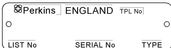
La targhetta del numero di serie si trova sopra la pompa di iniezione del carburante sul lato destro del monoblocco.
