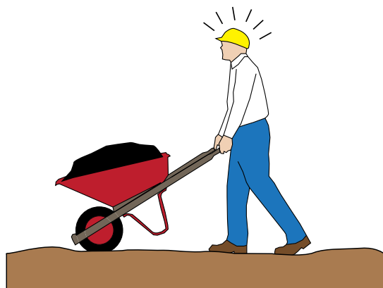
Тачка вязнет в слабом грунте, что увеличивает усилие ее толкания.
