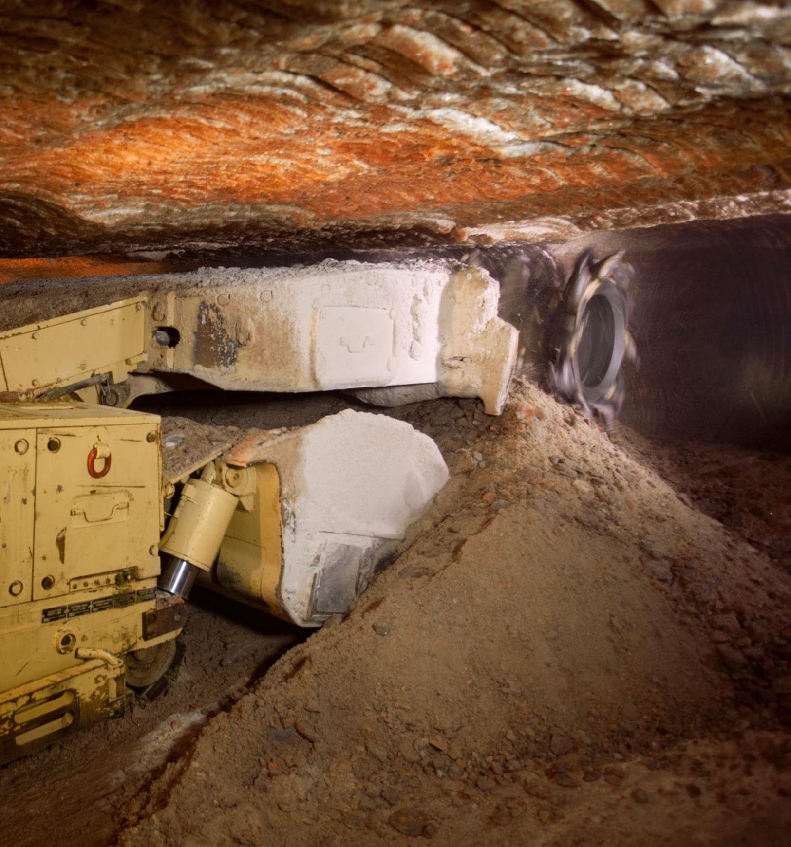
**Комбайн непрерывного действия континуус майнер Cat® CM445 для проходки в рекомендуемом диапазоне от 1626 мм до 3810 мм для работ в шахтах с углем с повышенным сопротивлением резанию, где требуется более высокое соотношение массы машины к ее мощности. Прочная режущая головка делает CM445 лучшим выбором для выемки угля высокой твердости, троны и калийных солей.**
