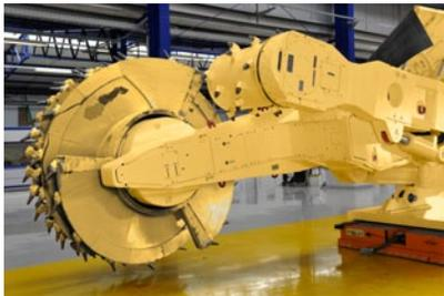
Очистные комбайны Cat могут быть оборудованы угольной дробилкой мощностью до 200 кВт (268 л.с.) для максимальной производительности при мощных пластах или трудных условиях добычи. Угольную дробилку можно заказать отдельно, для установки во время перемонтажа или капитального ремонта.
