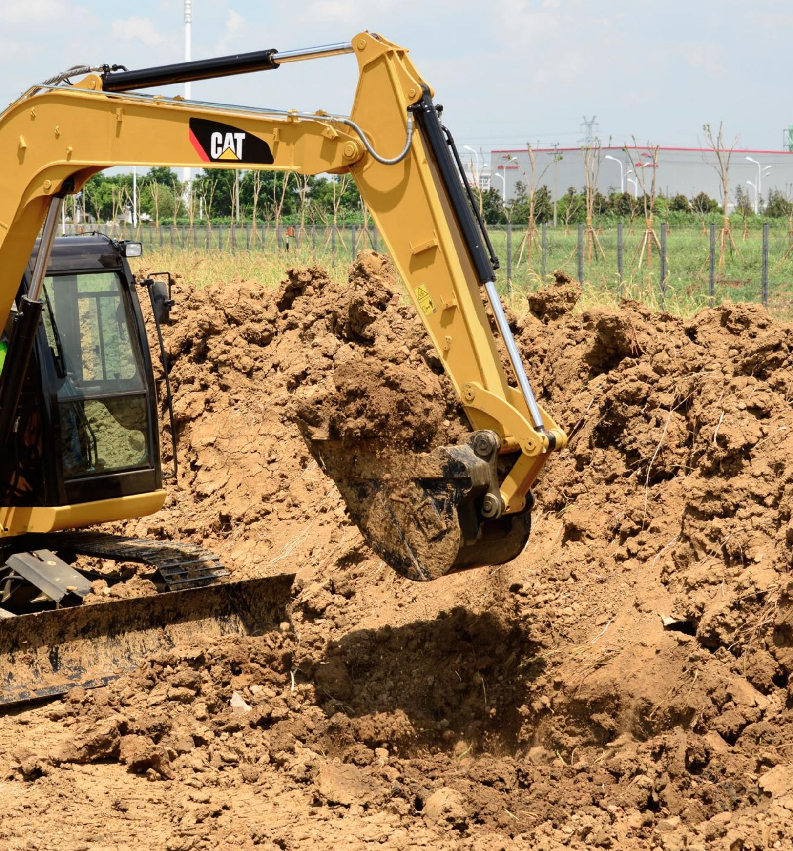
**Cat 307E 小型液压挖掘机性能优越，操作舒适，同时还可为您降低油耗和运营成本。宽敞的驾驶室提供舒适的工作环境。安装在座椅上的直观控制装置便于操作，提高了作业的精准度和效率。标准有尾回转设计，配重设计在机身更靠后的位置。这样可形成一个杠杆，为提升和挖掘作业提供稳定的工作平台。307E 堪称七吨级传统有尾回转挖掘机的典范。**
