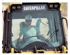
**Área de visión.** Las grandes ventanas poseen vidrios polarizados para reducir los reflejos de luz y proporcionar una vista excelente del cucharón, las cadenas y alrededor del recinto del motor hacia la parte trasera.
