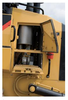
Compartimientos situados en el lado izquierdo. La parte inferior de la puerta del compartimiento se puede utilizar como peldaño para acceder al orificio de llenado del tanque de derivación, el antefiltro de aire (si está instalado) y permite una fácil limpieza de la ventana trasera.
