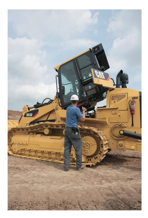
**Cabina inclinable.** El 963D está equipado con una cabina inclinable. Esta nueva característica hace más fácil el mantenimiento y las reparaciones. Al inclinar la cabina se obtiene acceso al tren de impulsión y se puede realizar el servicio completo al sistema hidráulico.
