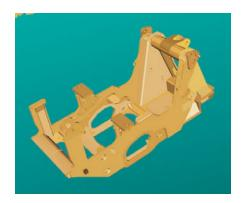
Bastidor principal y torreta del cargador. El Bastidor Principal y Torreta del Cargador del 963D están fabricados de rieles de placas sencillas con travesaños reforzados, con fundiciones y piezas forjadas incorporadas en los puntos de alta tensión para distribuir esas fuerzas de tensión en áreas más amplias para proporcionar una vida útil estructural más prolongada.
