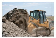
Bombas de desplazamiento variable y motores de impulsión. Las bombas e desplazamiento variable y los motores de mando son controlados electrónicamente por el EHC, que ofrece una alta eficiencia y un desplazamiento preciso. Cada cadena es impulsada independientemente por un circuito hidráulico diferente compuesto por una bomba conectada por mangueras hidráulicas y acoplamientos Cat XT-6™ a un motor de pistones.
