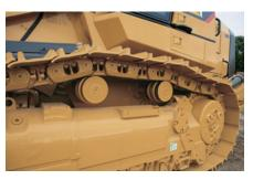
Rodillos superiores. El modelo 963D cuenta con siete rodillos de cadena, que distribuyen el peso de la máquina en un área amplia y dos solo rodillos superiores sobre cada montaje lateral del bastidor principal de la máquina.
