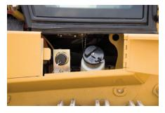
**Llenado de combustible.** El tanque de combustible y el orificio de llenado rápido optativo se ubican en el compartimiento del lado derecho, debajo de la entrada a la cabina.
