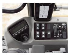
Sistema de arranque. El Interruptor Selector de Velocidad Electrónico (A), un interruptor basculante situado en la consola derecha, establece las rpm del motor. El controlador del motor ADEM A4 siempre arrancará el motor en velocidad baja en vacío. Las rpm del motor se pueden ver en la pantalla digital del conjunto de instrumentos en el grupo medidores o en el menú de rendimiento en Messenger.
