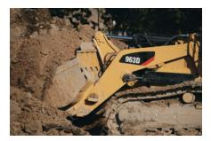
Cucharón de uso general. El cucharón de uso general (GP) ha sido diseñado para proporcionar excelente capacidad de carga y larga duración en una amplia variedad de aplicaciones, como excavación de bancos duros, levantamiento de sobrecapas y tareas de acopio. El acero de alta resistencia y baja aleación contribuye a que el cucharón resista las abolladuras y abrasiones. El borde trasero del cucharón está diseñado para una mejor eficiencia en las labores de enrase.
