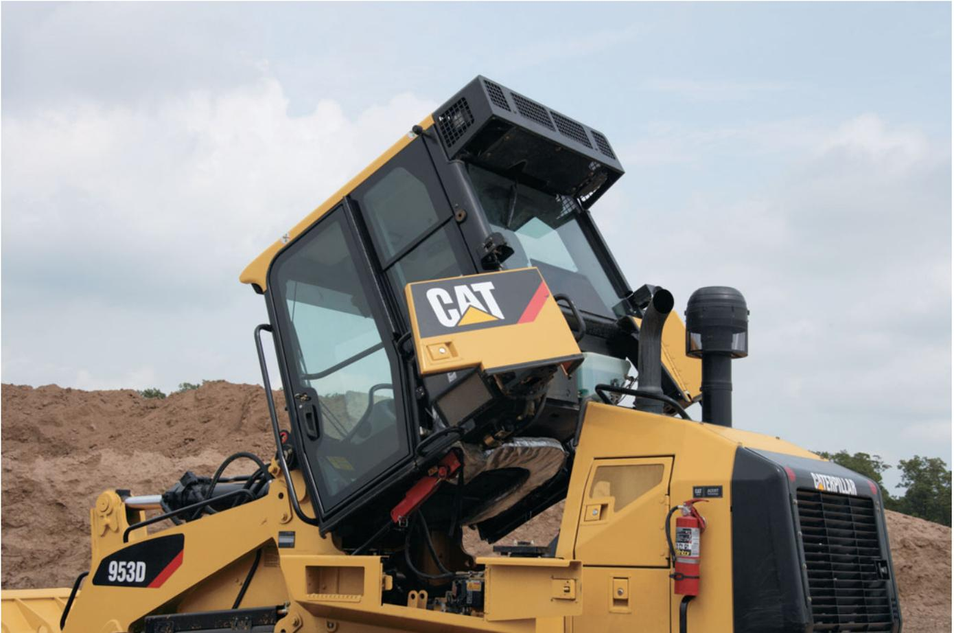
**Cabina inclinable.** El 953D está equipado con una cabina inclinable. Esta característica hace más fácil el mantenimiento y las reparaciones. Al inclinar la cabina se obtiene acceso al tren de impulsión y se puede realizar el servicio completo al sistema hidráulico.
