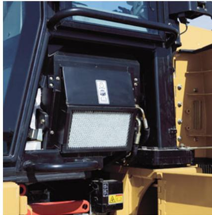
**Filtro de aire de la cabina.** El filtro de aire de la cabina, las tomas agrupadas de presión, la barra de bloqueo de inclinación de la cabina, el cilindro de inclinación optativo y la caja de herramientas están situados cómodamente debajo de la ventana izquierda de la cabina.
