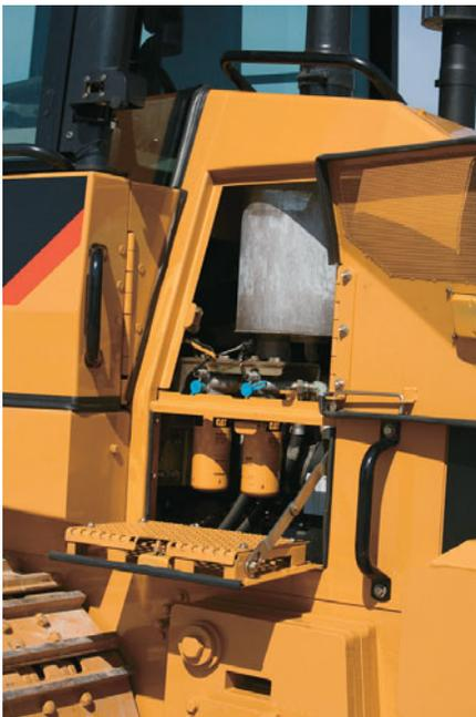
**Compartimientos situados en el lado izquierdo.** El compartimiento izquierdo del motor incluye dos filtros enroscables de aceite hidráulico que filtran el sistema hidrostático.
