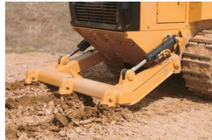
**Desgarrador-Escarificador.** Hay un desgarrador-escarificador radial disponible para el cargador 953D como accesorio. Está montado con dos pasadores que lo unen a cada lado del bastidor principal. Dos cilindros levantan y bajan el desgarrador. La viga del desgarrador tiene tres bolsillos para sostener los vástagos del desgarrador. Los seis pasadores del varillaje no requieren lubricación.
