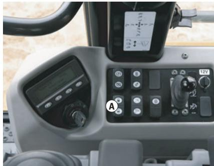
**Sistema de arranque.** El Interruptor Selector de Velocidad Electrónico (A), un interruptor “basculante” situado en la consola derecha, establece las rpm del motor. El controlador del motor ADEM A4 siempre arrancará el motor en velocidad baja en vacío. Las rpm del motor se pueden ver en la pantalla digital del conjunto de instrumentos en el grupo medidores o en el menú de prestaciones de Messenger.
