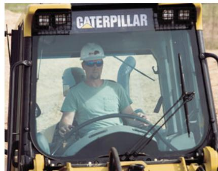
**Área de visualización.** Las grandes ventanas poseen vidrios polarizados para reducir los reflejos de luz y proporcionar una vista excelente del cucharón, las cadenas y alrededor del recinto del motor hacia la parte trasera. Las ventanas laterales se deslizan desde arriba hacia abajo para permitir el ingreso de aire fresco hacia la cabina y permitir que el operador se comunique.
