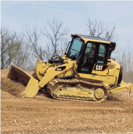
**Controles electrohidráulicos de los implementos.** Los controles electrohidráulicos del implemento en el 953D proporcionan al operador un control sensible, suave y preciso del cucharón y de los brazos de levantamiento, permiten también al operador ajustar parámetros personales a través de Messenger optativo, como las reacciones del implemento.
