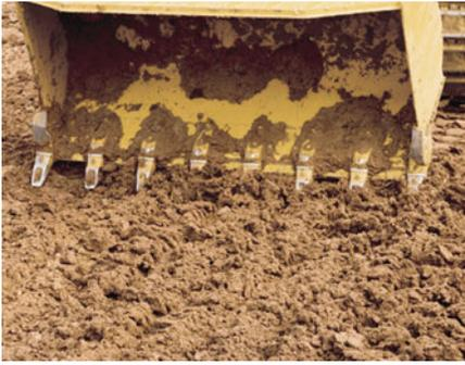
**Cucharón de uso general.** El cucharón de uso general (GP) ha sido diseñado para proporcionar excelente capacidad de carga y larga duración en una amplia variedad de aplicaciones, como excavación de bancos duros, levantamiento de sobrecapas y tareas de acopio. El acero de alta resistencia y baja aleación contribuye a que el cucharón resista las abolladuras y abrasiones.
