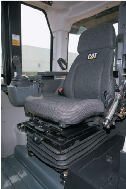
**Asiento Caterpillar con suspensión neumática.** El asiento Caterpillar con suspensión neumática, con aislador de lado a lado, tiene un diseño ergonómico y totalmente ajustable para una máxima comodidad y control del operador. El cinturón de seguridad retráctil mide 75 mm (3 pulg) de ancho para ofrecer una sujeción firme y cómoda.
