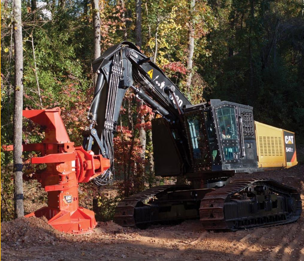
Los feller bunchers de cadenas Serie 2 tienen rendimiento hidráulico más uniforme, mayor ahorro de combustible, estación del operador más cómoda y mejor visibilidad. Los modelos Cat® 541 serie 2 y 552 serie 2 son máquinas de giro total de la cola diseñadas para corte limpio de alta producción y para corte limpio o seleccionado en terreno irregular. El modelo 552 serie 2 es una máquina de nivelación para mayor comodidad en terreno empinado.
