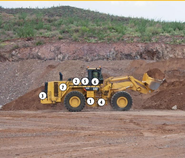
Модель 992К отличается сгруппированными точками технического обслуживания. В сочетании с такими средствами диагностики, как VIMS, Product Link и Electronic Technician техническое обслуживание модели 992К отличается простотой и эффективностью.
