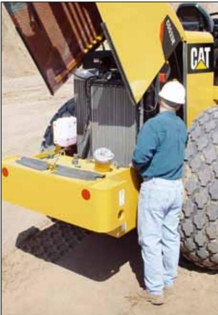
El capó de fibra de vidrio se inclina hacia adelante para un buen acceso al motor y al sistema de enfriamiento. Los puntos de servicio diario se acceden desde el nivel del suelo y están agrupados en un lado de la máquina.
