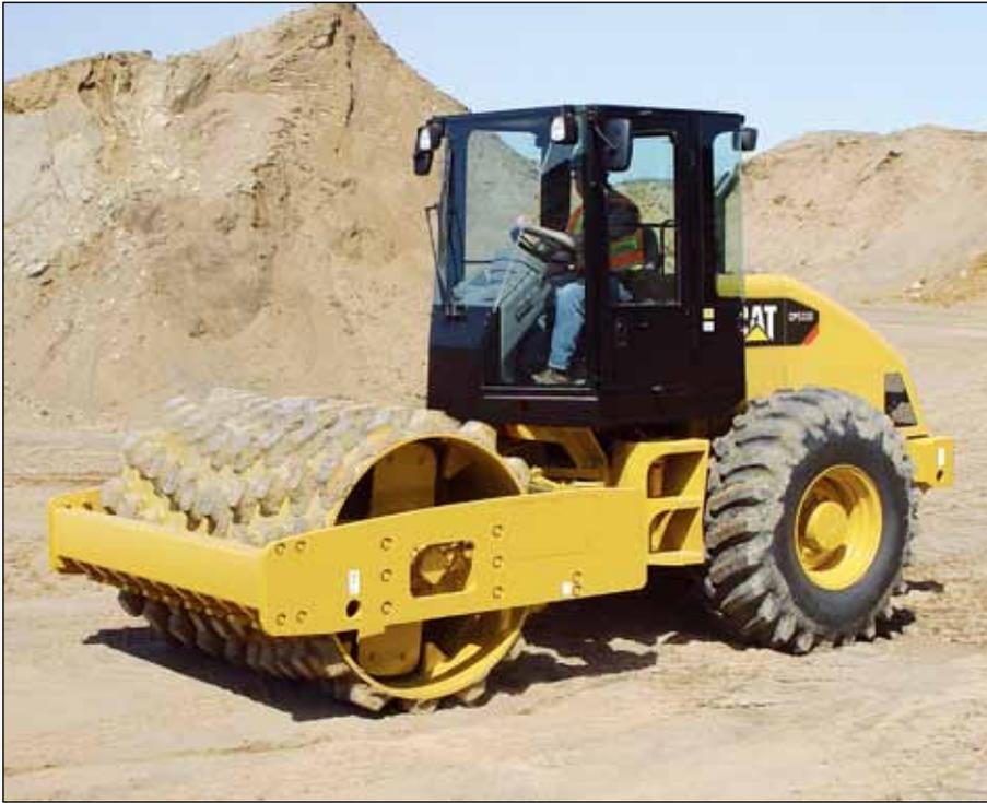
**Los raspadores de trabajo pesado** montados en la parte delantera y trasera de la horquilla del tambor, son individualmente ajustables y sustituibles. Ayudan a reducir el exceso de material acumulado entre los pisones.
