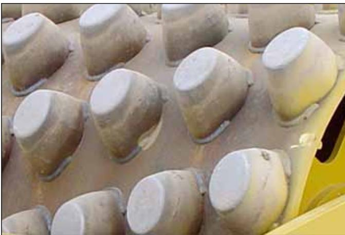
**Este diseño de pisones es ideal para la compactación de capas más gruesas de arcilla**, con grosores de más de 25 – 45 cm (10 – 18") de material pesado de arcilla, debido a la mayor altura del pisón para penetración profunda en la capa. El área menor de la superficie del pisón permite una mayor presión de contacto con el suelo para lograr la densidad deseada rápidamente y para cumplir con las especificaciones estrictas de densidad.
