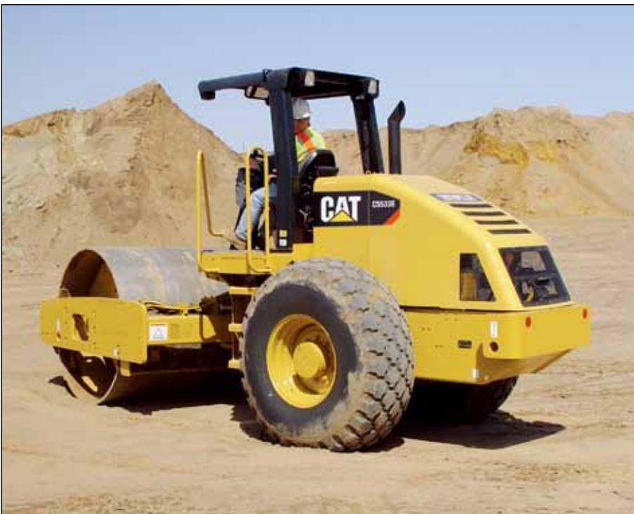
**La visibilidad** hacia los bordes de los neumáticos y la parte trasera de la máquina es excepcional. El capó inclinado le permite al operador ver obstáculos que miden 1 metro (3' 3") de altura ubicados a 1 metro (3' 3") detrás de la máquina. La excelente visibilidad aumenta la productividad cuando se trabaja cerca de obstrucciones o maniobrando alrededor del sitio de la obra.
