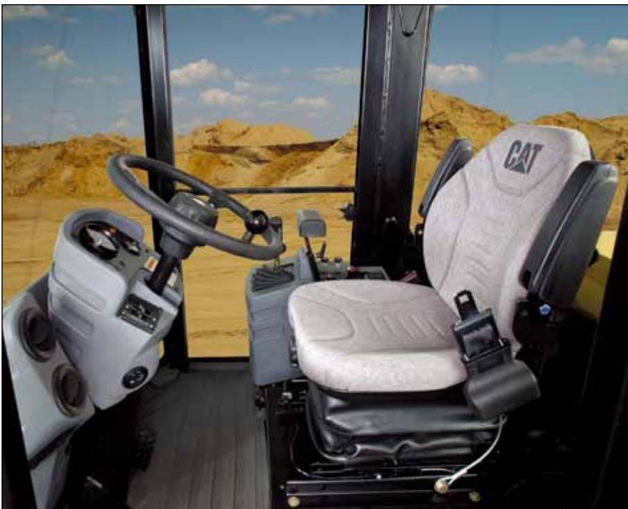
**La palanca única de control** para propulsión y vibración conectada/desconectada proporciona operaciones simples y de bajo esfuerzo. Un posamuñecas acolchado y ajustable proporciona comodidad.
