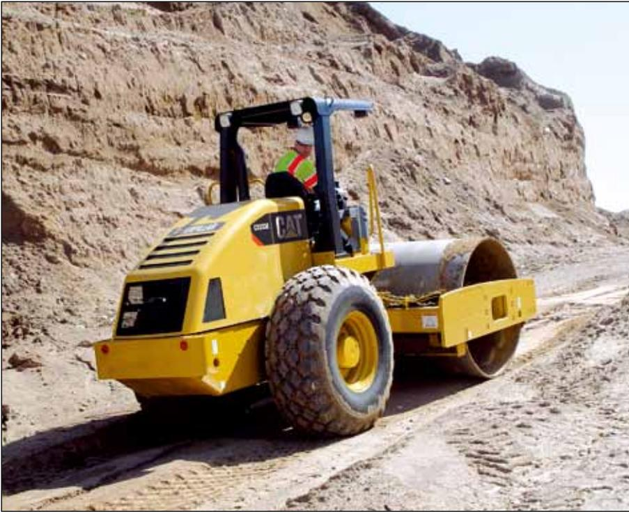
**El sistema de bombas dobles de propulsión** posee bombas dedicadas para accionar los motores de servicio pesado y alto par de las ruedas traseras y del tambor en forma independiente. Si el tambor o las ruedas empiezan a patinar, el motor que no está patinando continua recibiendo flujo hidráulico, permitiendo un esfuerzo de tracción continuo especialmente útil en suelos desagregados o inestables.
