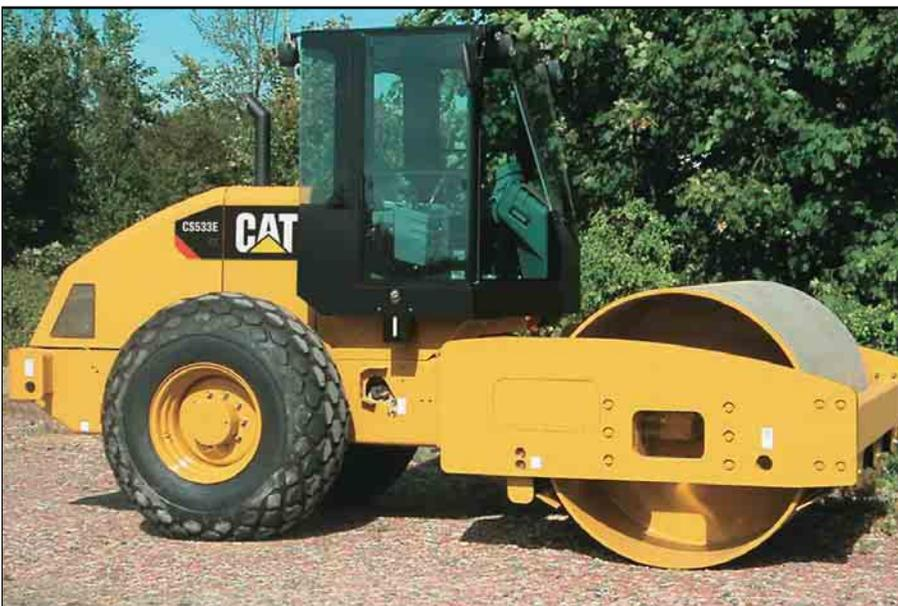
**Machine plus lourde.** Le poids en ordre de marche est supérieur d'environ 1500 kg par rapport au modèle standard CS533E. Lorsque la machine est équipée de cette option, le CS533E version lourde se classe parmi les 12-15 t.
