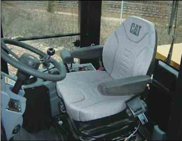
**Commande par levier unique.** Un levier unique permet de commander, de manière simple et sans effort, la mise en marche et l'arrêt des systèmes de translation et de vibration. Un repose-poignet rembourré et réglable procure davantage de confort.
