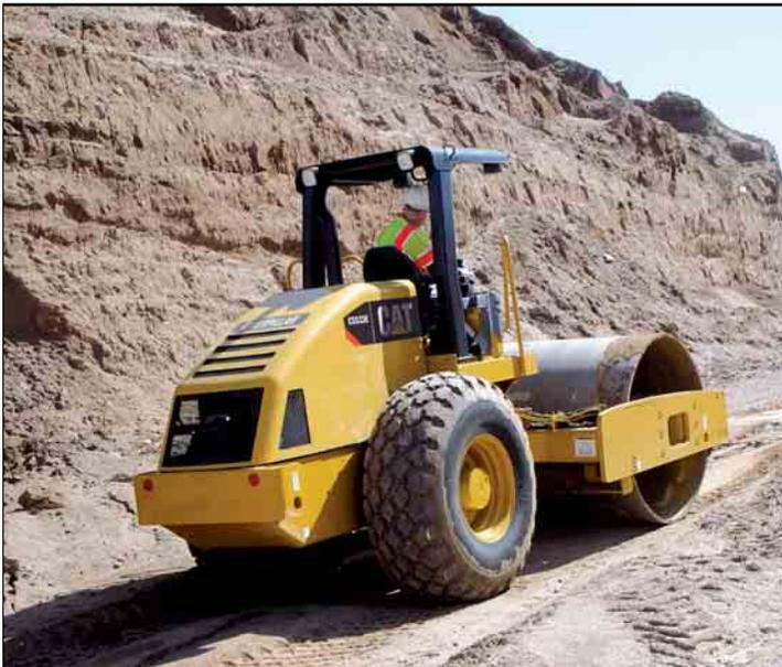
**Circuit de translation.** Dans le circuit de translation à pompes jumelées, des pompes spécifiques entraînent séparément les puissants moteurs à couple élevé des roues arrière et du cylindre. En cas de patinage du cylindre ou des roues, le débit hydraulique est maintenu vers l'autre moteur, garantissant ainsi un effort de traction continu, ce qui s'avère particulièrement utile sur terrain mou.
