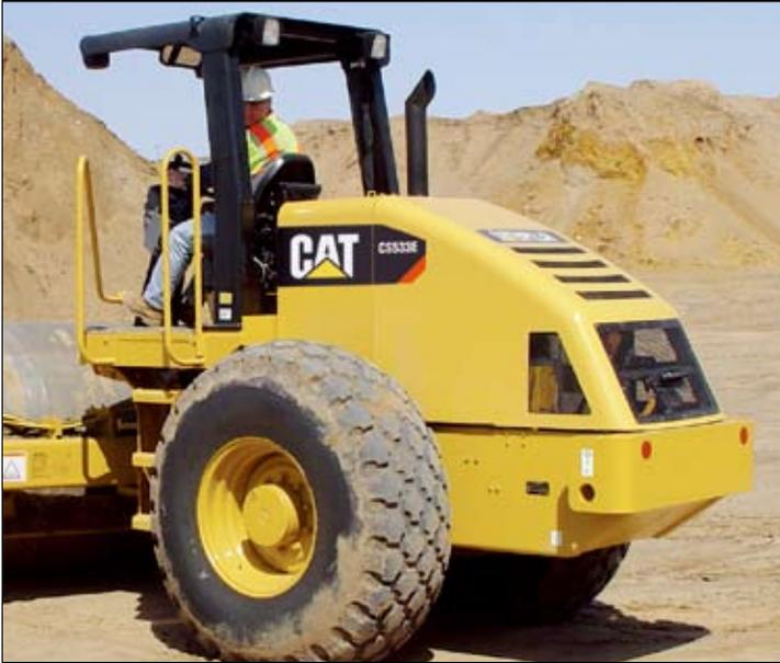
**视野。**轮胎边缘和机器后部的视野特别好。倾斜的发动机罩使操作员能看到离机器后部 1 米远处 1 米高的障碍物。在靠近障碍物工作或在现场行驶时，良好的视野能提高生产率。
