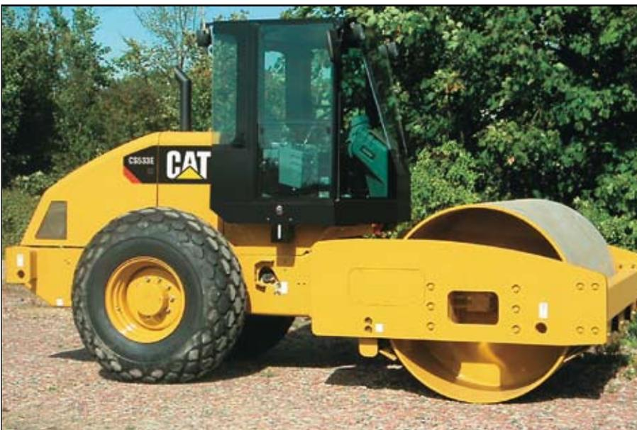
**增加的机器重量。**工作重量比标准的CS533E 重约 1500 kg。CS-533E 配置这种选装件后，在 12-15 公吨级的机器中具有很强的竞争力。
