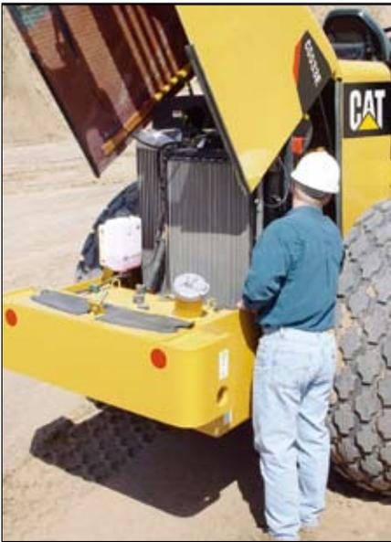
向前倾斜的玻璃纤维罩，方便您检修发动机和冷却系统。日常维护点集中到机器的一侧，从地面即可接触。
