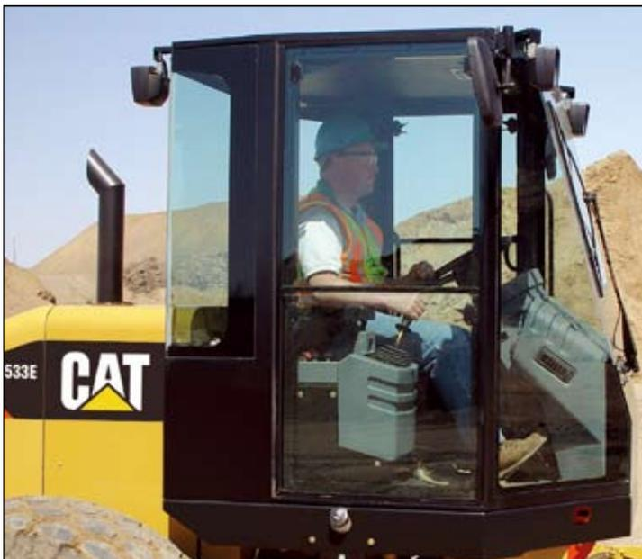
**驾驶室。**驾驶室提供了宽敞、舒适的工作环境，包括有大玻璃窗、带储藏区的更大内部空间、茶杯架、更好的人机工程设计和较低的噪声等级。
