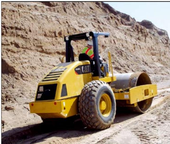
**推进泵系统。**双推进泵系统对泵进行分配，以分别驱动重载、大扭矩的后车轮和碾轮马达。如果碾轮或车轮开始打滑，不打滑的马达仍然得到液压流，保持连续的牵引力，这在松散的地面条件下尤为有用。
