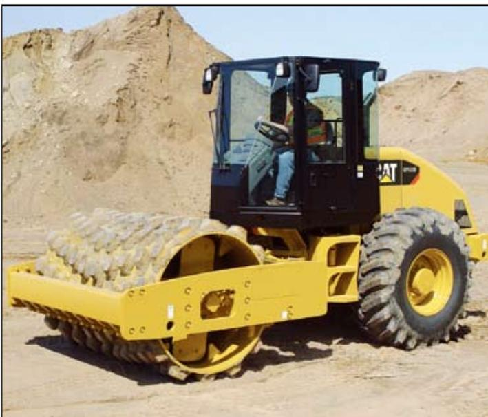
**凸块碾轮。**凸块碾轮有 140 个凸块以 V 形排列焊接在钢轮上。
