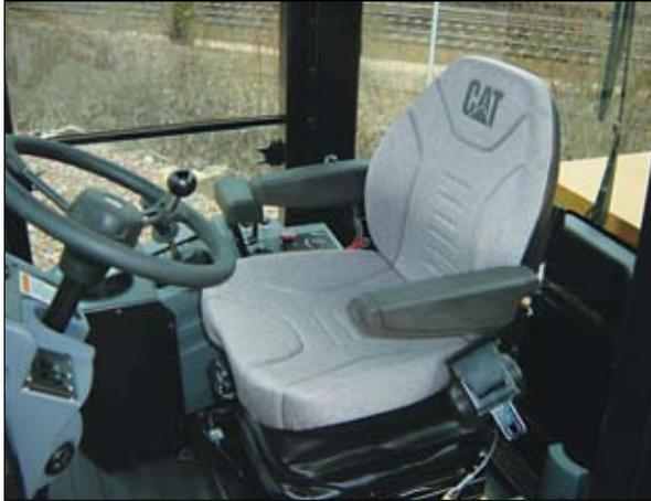
**单杆控制。**通过单独的操纵杆来控制推进和振动开关，使操作更简单省力。有填充物的可调护腕垫使操作更舒适。
