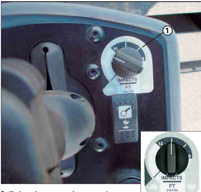
1 Cadran de commande automatique de vitesse
