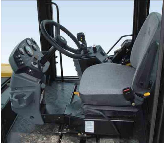
**Siège.** Siège confortable et robuste avec réglages de la profondeur et de la dureté de la suspension, accoudoirs relevables et ceinture de sécurité de 76 mm de large, à enrouleur.
