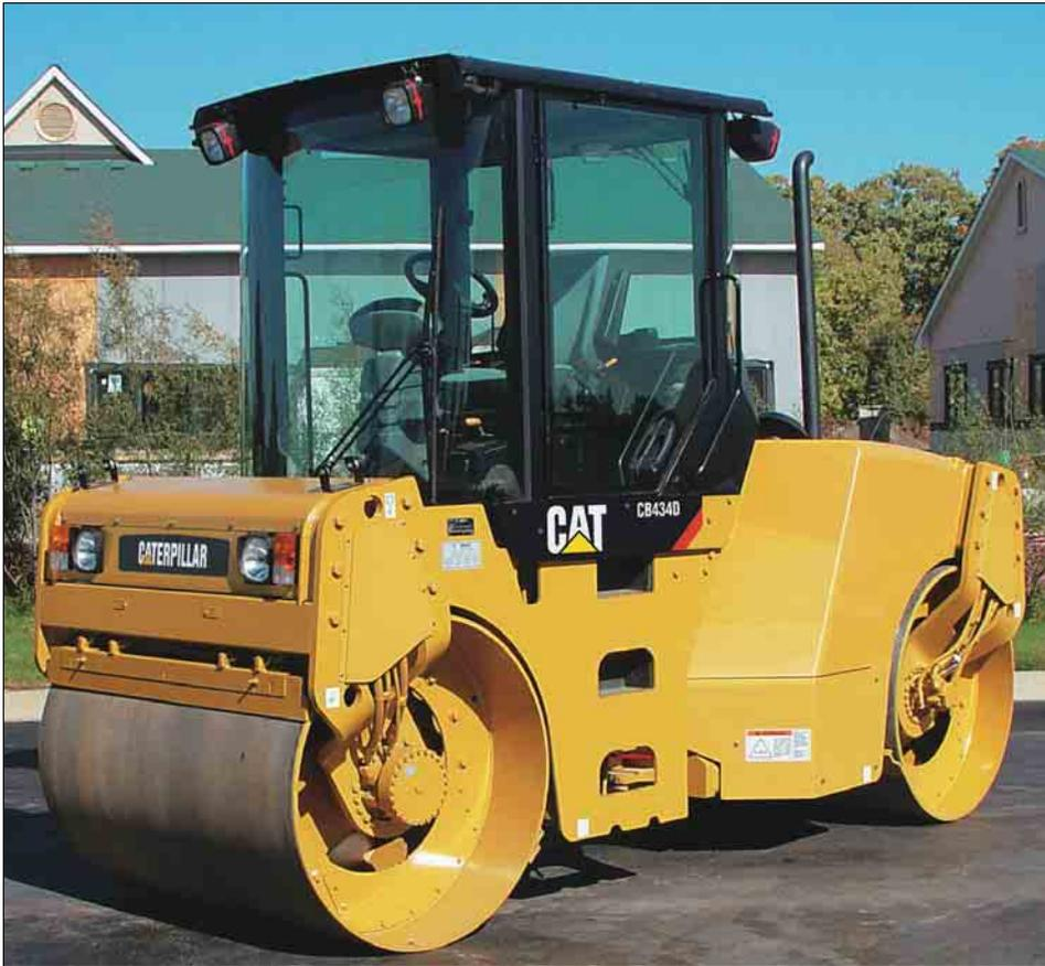
**Version de capot.** La version de capot à levage vertical permet de procéder à l'entretien courant même à proximité d'autres machines ou de structures.
