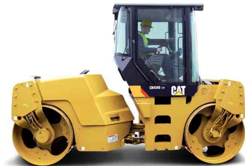
**Largeur accrue de cylindre.** Le CB434D XW présente une largeur de cylindre de 1,70 m qui offre une meilleure couverture et permet ainsi de réduire le nombre de passes.
