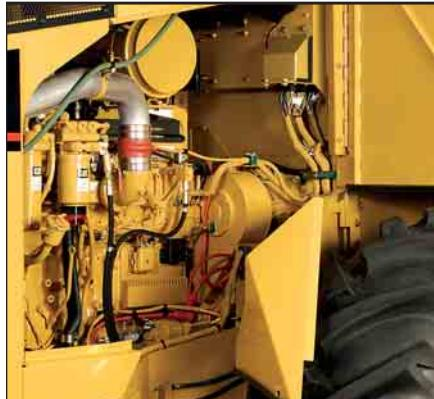
Точки ежедневного обслуживания сгруппированы с одной стороны двигателя и доступны с уровня земли. Боковые лючки на петлях широко открываются, обеспечивая полный доступ к элементам двигателя с уровня земли. Для улучшения доступа нижние боковые лючки могут быть легко сняты.
