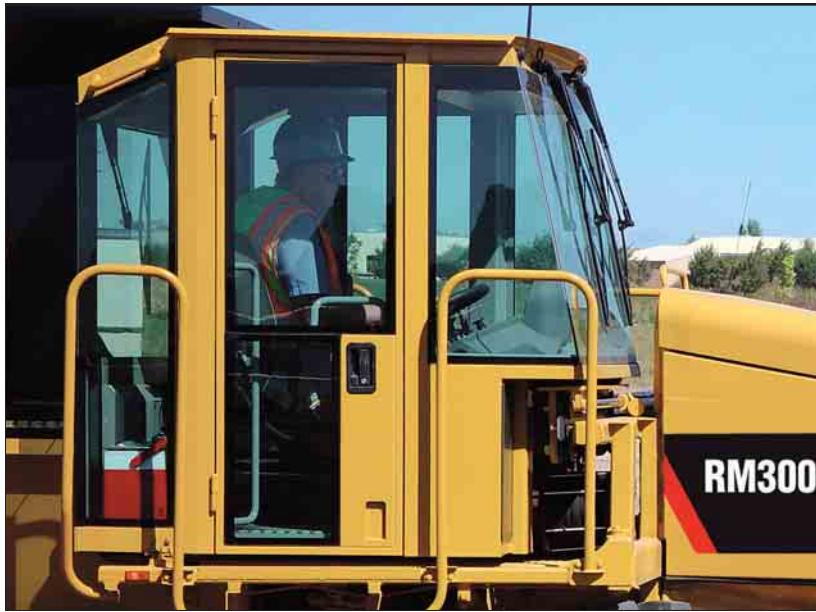
Кабина, в которой поддерживается избыточное давление, установлена на демпфирующих опорах. В комфортной, шумоизолированной и герметизированной кабине созданы прекрасные условия для работы.
