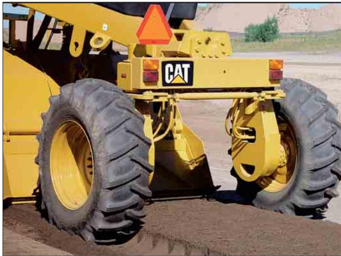
**Два насоса ходовой части.** Один насос предназначен для привода передних колес, второй — задних.
