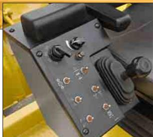
*La console latérale comprend un accoudoir rembourré, le contacteur des quatre modes de direction, le bouton de commande de vitesse, le levier de translation et des contacteurs (commande de hauteur du rotor, portes avant et arrière du caisson de rotor, direction des roues arrière et déplacement du poste de conduite).*
