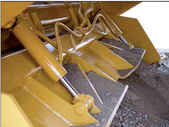
**Porte avant à commande hydraulique.** Permet au conducteur de commander l'ouverture depuis le poste de conduite.
