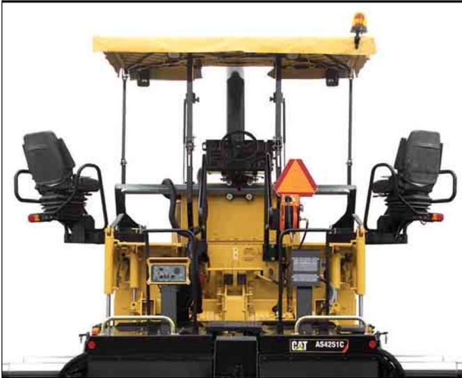
**Sichtverhältnisse.** Der geräumige, ergonomisch gestaltete Doppelbedienstand weist zwei seitlich bis über den Maschinenrahmen hinaus verschiebbare Sitze und ein über die gesamte Breite auf Rollen verschiebbares Bedienpult auf, um eine optimale Rundumsicht für den Bediener zu schaffen. Auch der niedrig eingebaute Dieselmotor ermöglichte eine weitere Verbesserung der Sicht auf den vorderen Arbeitsbereich und in den Kübel.
