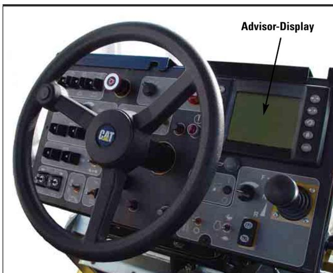
**Funktionen.** Zum AMS (Advisor Monitoring System) gehören u.a. Projektplanungsrechner, Inbetriebnahme-Prüflisten, Betriebsparameteranzeigen und viele andere Funktionen zur Unterstützung des Bedieners. Beispiele der möglichen Einstellungen und Anzeigen:
