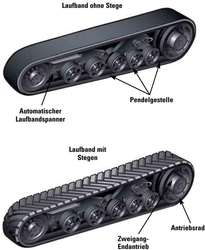
**Eigenschaften.** Im Mobil-trac-System vereinen sich die Vorteile von Rad- und Kettenlaufwerken, sodass die Maschine mit bester Traktion, niedrigem Bodendruck und beeindruckender Manövrierfähigkeit aufwartet. Die langlebigen, aus hochfestem Gummimaterial hergestellten Laufbänder werden durch mehrere Lagen aus flexiblen Stahlseilen verstärkt.
