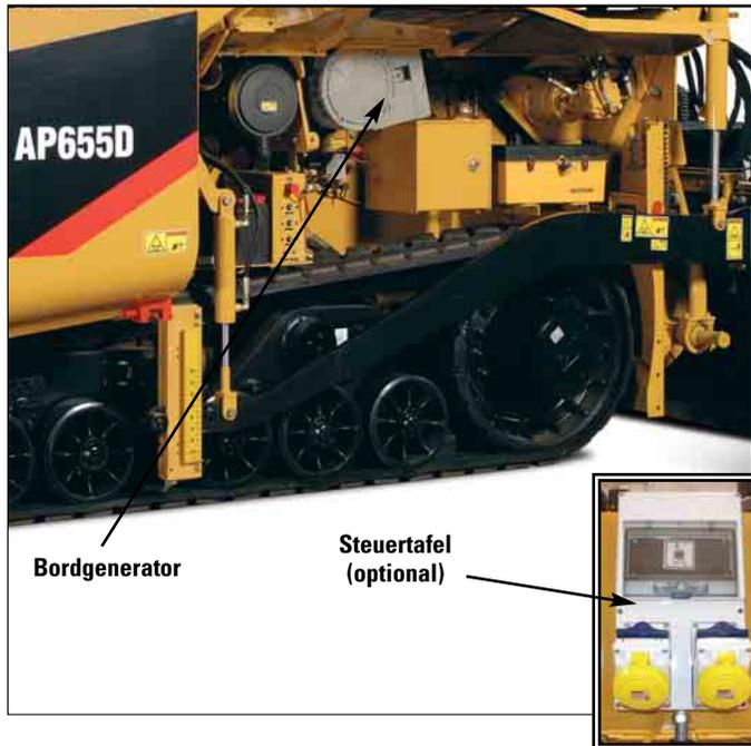
**Leistung.** Der integrierte und auf Vollast-Dauerbetrieb ausgelegte Generator gibt seine Höchstleistung von 25 kW bereits bei einer Dieselmotor-Drehzahl von 1275/min ab, sodass stets genügend Strom für Bohlenheizung und Arbeitsscheinwerfer verfügbar ist.
