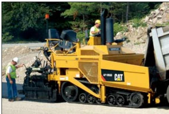
**Pavimentadora de Asfalto AP1055D (Mobil-trac™ o de cadena de acero)**
