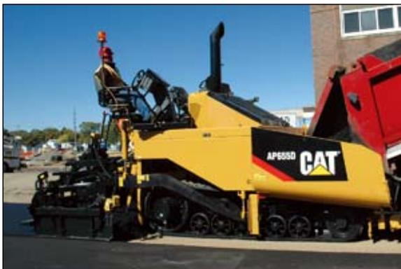
**Pavimentadora de Asfalto AP655D (Mobil-trac™ o de cadena de acero)**
