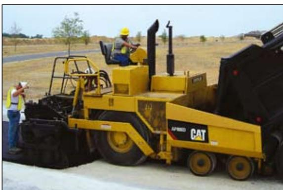
**Pavimentadora de Asfalto AP800D (de ruedas)**
