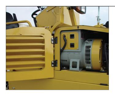
**Generador industrial de CA de una fase.** El generador incorporado optativo suministra energía simultáneamente a los elementos de calentamiento del reglón eléctrico, las luces auxiliares y las herramientas del sitio de trabajo. El generador proporciona 12 kW de potencia para el reglón, 220 V para el sistema de iluminación nocturna y 1,5 kW de suministro eléctrica normal.
