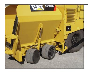
**Tractor de ruedas.** La AP300 incorpora dos neumáticos de tracción con banda de rodadura amplia, los que impulsan la máquina, y cuatro ruedas direccionales delanteras con soportes basculantes. Estas cuatro ruedas de caucho macizo están montadas en los balancines del eje oscilante delantero, lo que proporciona el máximo contacto con el suelo y funcionamiento uniforme en puntos altos y bajos.
