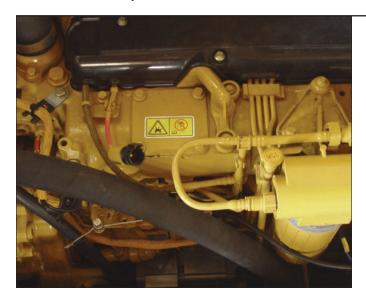
**Motor Cat 3054C DINA.** El motor 3054C genera una potencia bruta nominal plena (SAE J1995) de 52 kW (71 hp) a 2.200 rpm. Cumple las regulaciones de emisiones europeas para motores EU Stage II.
