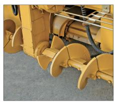
Conjunto de sinfines de altura ajustable. Los sinfines son reversibles y su altura se puede ajustar con un sistema hidráulico, lo que beneficia a la calidad de la capa y mejora la distribución del material delante de la regla.
