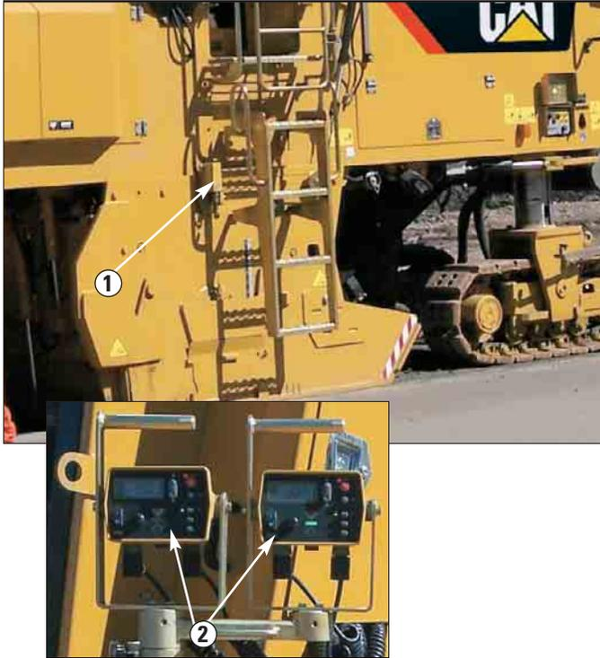
**Capteurs de nivellement.** Les capteurs peuvent être facilement positionnés de chaque côté de la machine et fournir une précision homogène. Le capteur de nivellement transversal (pendule) permet de créer un profil transversal.
