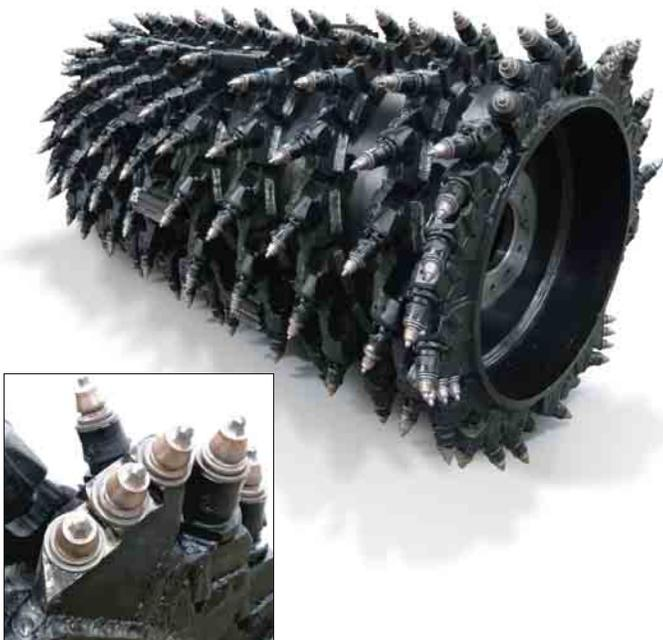
**178 pics hexagonaux au carbure.** Les outils de coupe sont montés dans de solides porte-dents en trois parties, à remplacement rapide. Les porte-outils d'extrémité disposés en groupes de trois permettent une coupe latérale franche. Les porte-dents coniques à démontage rapide garantissent un guidage parfait dans le temps, donc une excellente qualité du peigne.
