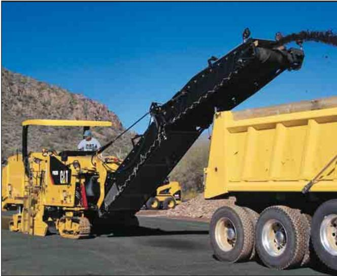
**Convoyeur repliable hydrauliquement.** Le convoyeur repliable hydrauliquement vers le haut réduit les dimensions de la machine et facilite le transport.
