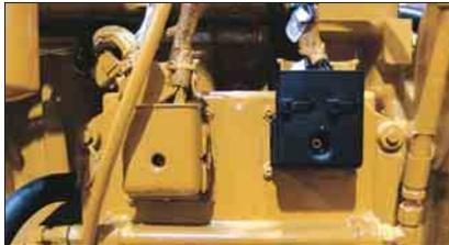
**Alimentation en carburant pour l'injection multipoint.** Le contrôle précis du cycle de combustion permet d'abaisser les températures dans la chambre de combustion, ce qui réduit les émissions polluantes et optimise la combustion, d'où un rendement supérieur par litre de carburant.
