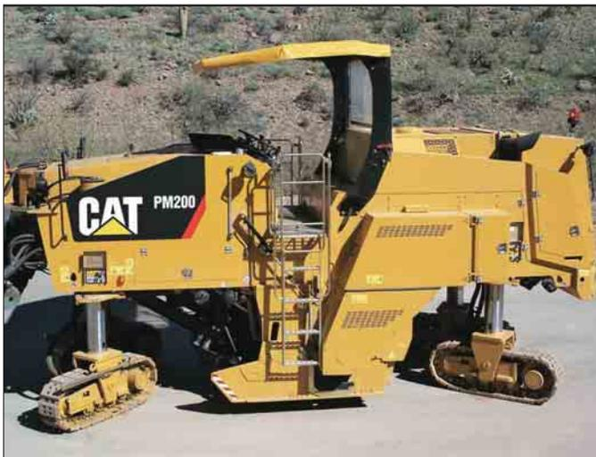
**Quatre modes de direction.** La commande de direction offre quatre modes pour manœuvrer facilement en espace restreint: chaînes avant uniquement, marche en crabe, direction coordonnée et chaînes arrière uniquement.
