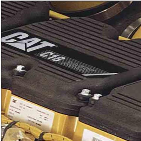
**Puissance optimum.** Le moteur développe une puissance brute nominale de 429 kW (583 ch) à 1900 tr/min avec un couple de 2718 Nm. La grosse cylindrée et le couple élevé font de la PM200 une machine très productive. La courbe de puissance du moteur est optimisée pour les applications de fraisage de façon à offrir une puissance maximum avec un rendement optimal.
