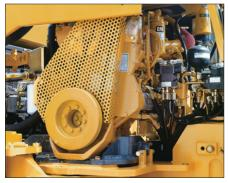
宽大的发动机检修门便于对发动机和 液压部件从地面进行进修。
