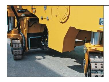
精确控制。微处理器对右后履带的转向角进行电子控制。后履带的转向角可自动调整,使其与前履带的位置对应。
