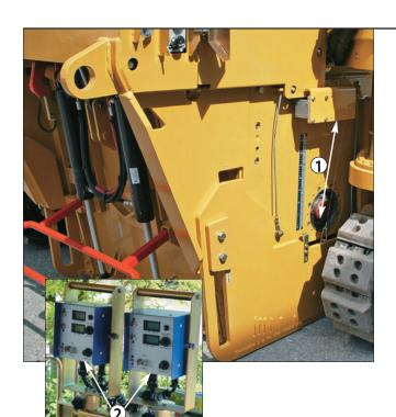
**接触式钢绳(上下移动)坡度传感器。**钢绳坡度传感器测量侧板的移动,把整个侧板长度作为平均量度,以确保精确的坡度匹配。横坡传感器增强了系统的多功能性。
