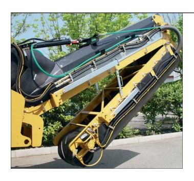
**折叠式传送带。**折叠式前部传送带减小了机器尺寸,使机器运输更加方便。
