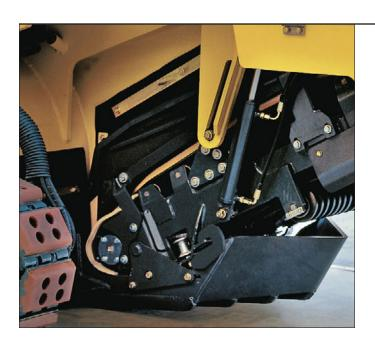
**最佳物料筛分和级配。**液压操作的抗混凝土板装置可防止 将路面切成板块,提供最佳物料筛分和级配,保护集料传 送带并确保转子室有最佳卸载口。
