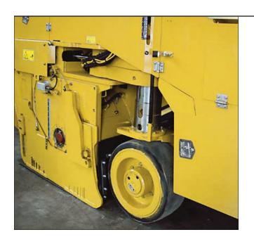
**总牵引力。**位于全部四个车轮上的静液压变速箱,通过流量分配器和自平衡前轴,确保了在所有应用中达到正牵引力和最佳性能。
