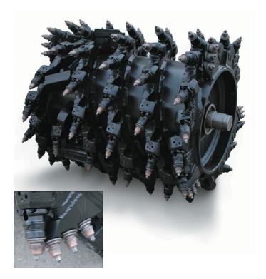
**97 个硬质合金刀头。**刀头安装在三件式快速释放刀座上,以三重刮板模式布置,可实现最大的挖掘力。
