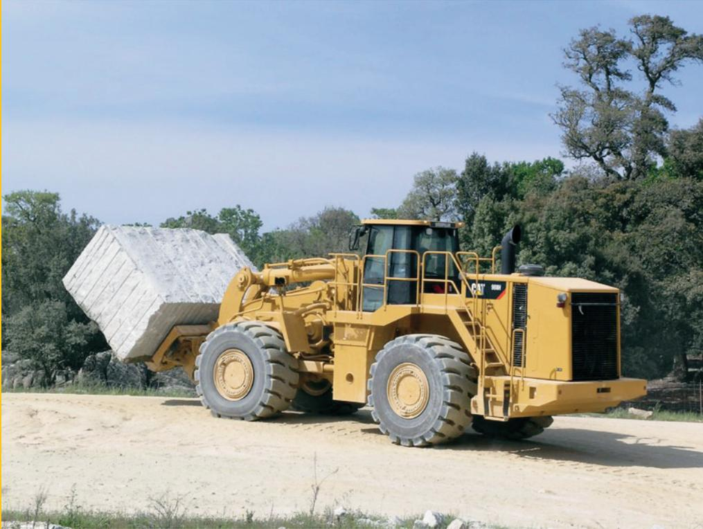
**Cat® 988H 大块物料处理机总成能够适应严苛、恶劣的大块物料处理应用环境。整个总成包括特制连杆、大型提升与倾斜油缸、附加配重和高轮辋牵引力动力传动系。请继续阅读下文，了解 988H 大块物料处理机如何提供可持续的生产率、燃油效率、维修保养方便性、可靠性和多功能性。**
